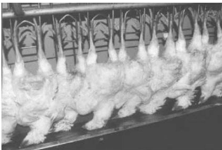
Figura 5: Estimulador eléctrico mostrando el contacto de las cabezas de las aves con la placa conductora.
