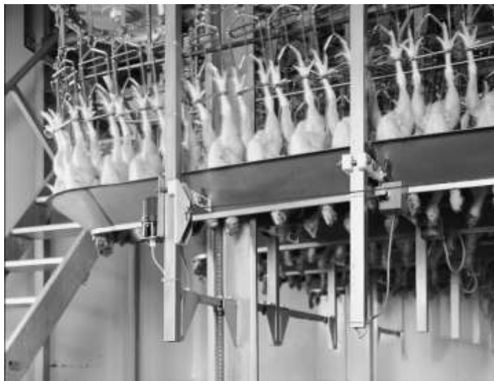
Figura 4: Estimulación eléctrica inmediatamente posterior al desplumado, mostrando el contacto de las pechugas con la placa conductora.
