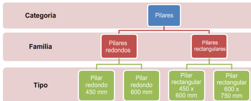
Figura 34 – Elementos de construcción paramétricos de Revit, 2013.
