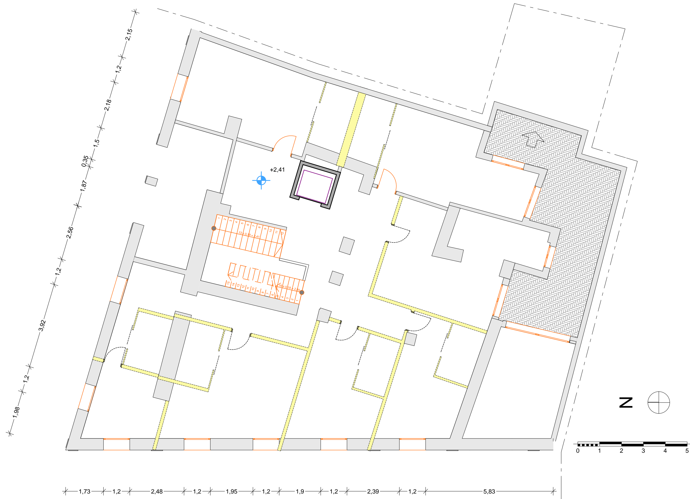
Demoliciones Entresuelo Escala 1/100
