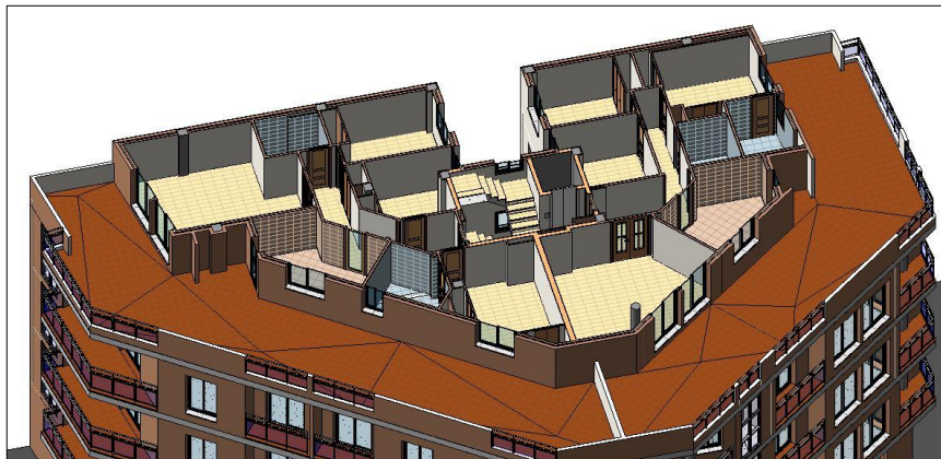
Figura 53. Perspectiva seccionada planta ático LOD 300. Fuente propia
