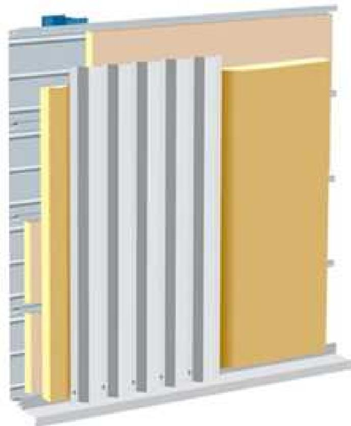
Figura 26. Detalle fachada panel sándwich in situ. Fuente: Incoperfil
