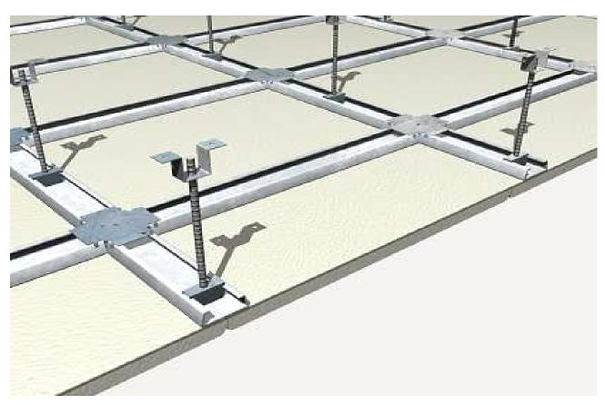
Figura 37. Falso Techo simple Knauf. Fuente: generadordeprecios.com
