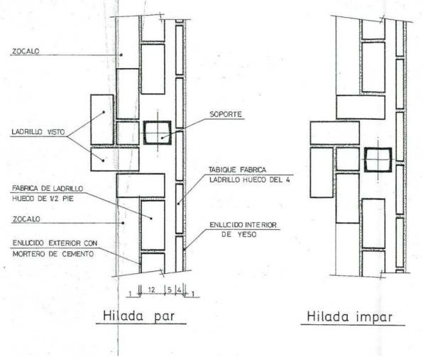
Figura 15. Detalle hilada fachada. Fuente: La empresa
