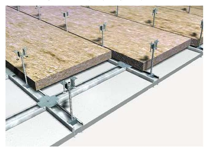
Figura 38. Falso techo con aislamiento térmico ignifugo. Fuente: generadoreprecios.com
