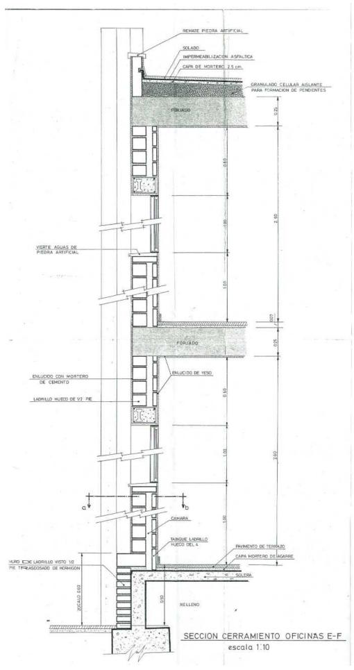
Figura 14.Detalle Fachada. Fuente: La empresa
