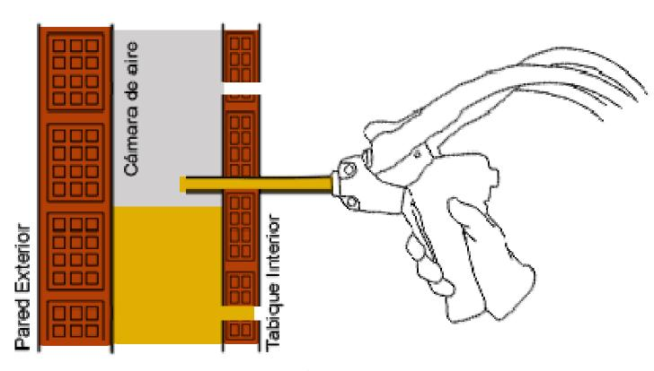
Figura 28. Detalle inyección aislamiento. Fuente: Imprimur.es
