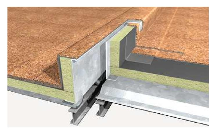
Figura 25. Detalle cubierta Deck. Fuente: Incoperfil
