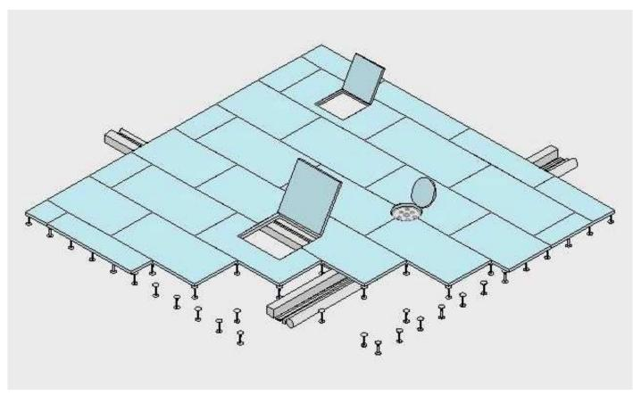
Figura 34. Detalle suelo técnico Knauf. Fuente: Knauf
