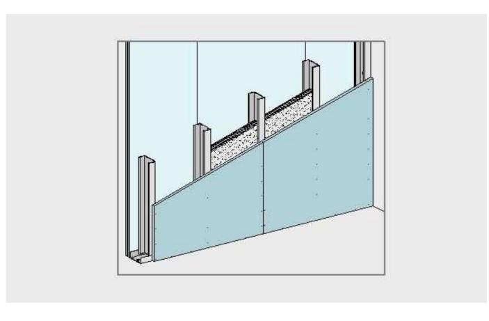
Figura 32. Detalle partición Knauf. Fuente: Knauf.
