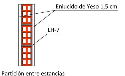
Figura 17. Detalle particiones existentes
