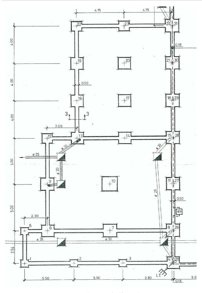
Figura 8. Extracto Plano cimentación edificio singular. Fuente: La empresa
