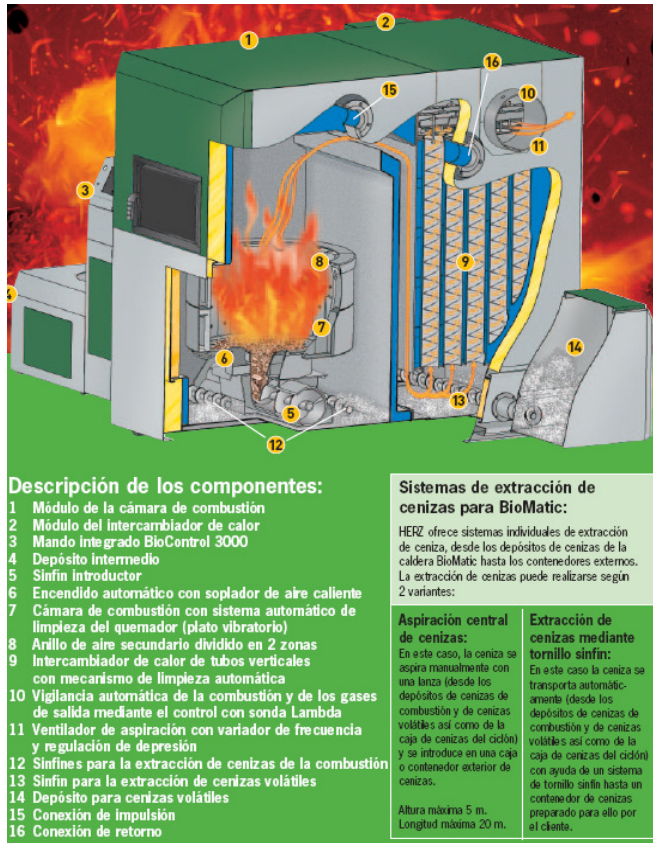
Figura 47: Descripción y características caldera Biomasa Herz Biomatic. Fuente: Herz
