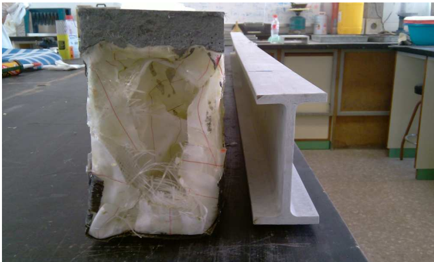
Fotografía 67: IPE-120·60·8 pultrusionado de GFRP y viga Híbrida cajón hecha a mano.
