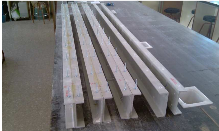
Fotografía 29: 4 Vigas de 2 UPN a tope pultrusionados de GRFP, sin capa de compresión.
