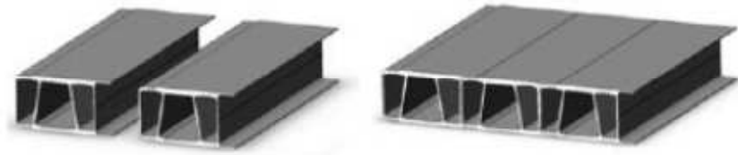
Figura 53: GFRP composite deck Con conectores machiembrados. (Lee and Hong, 2009)
