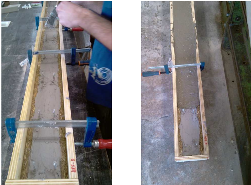
Fotografía 42: Encofrado capa compresión y resina epoxi interfase ala/HRF (izquierda) y hormigonado viga híbrida (derecha).
