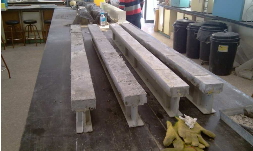
Fotografía 43: Vigas híbridas tras desencofrarlas.
