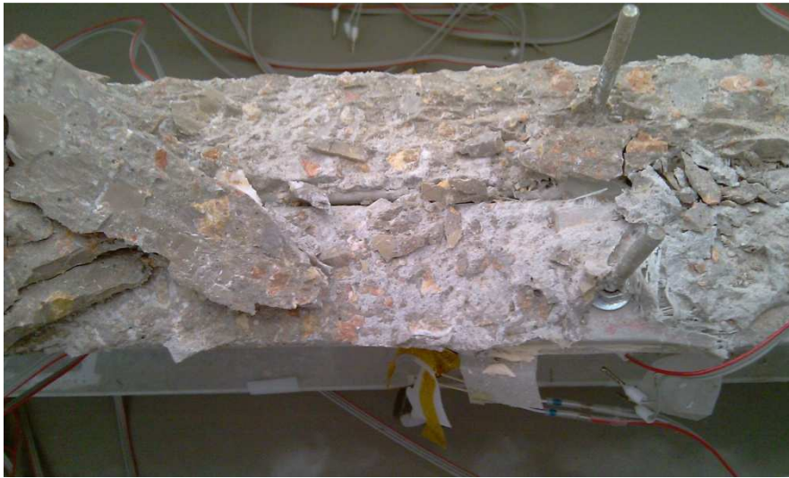
Fotografía 56: Interfase más débil resina epoxi/hormigón.
