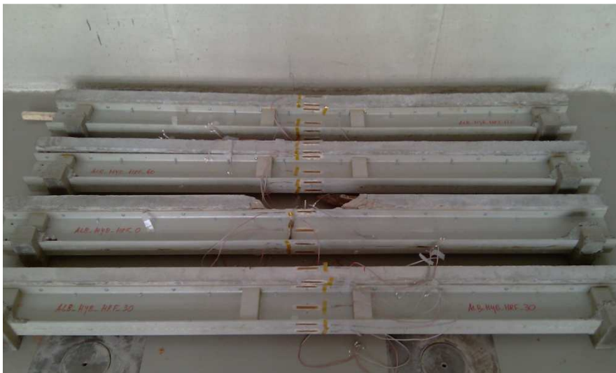
Fotografía 65: Recuperación de la flecha tras descarga de la viga después de ensayo de flexión 4 puntos de las viga híbridas.
