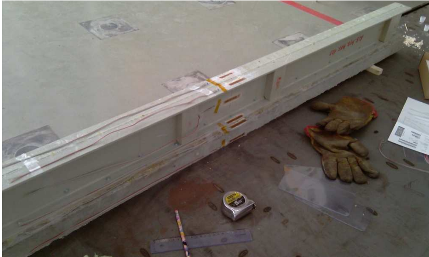
Fotografía 47: Colocación de galgas extensiométricas en las vigas híbridas.
