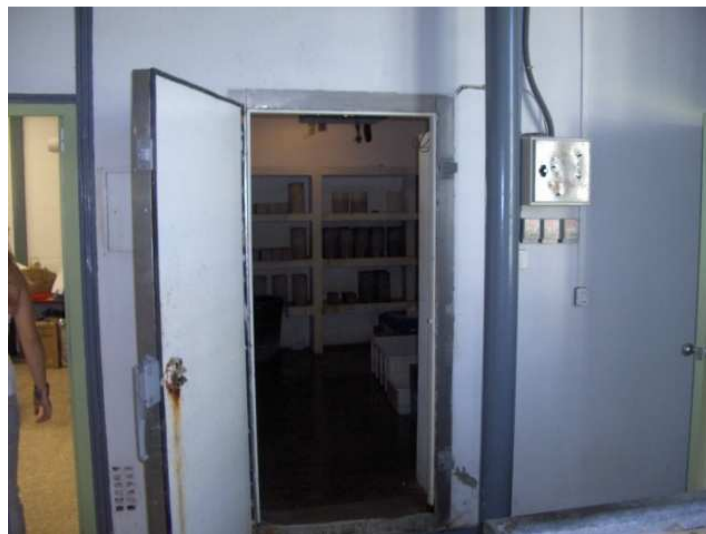
Fotografía 36: Cámara de curado utilizada a 24 °C y 95% HR.
