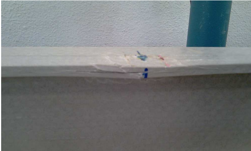
Fotografía 70: IPE-120 60 8 pultrusionado de GFRP, rotura por aplastamiento.
