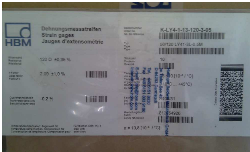
Fotografía 46: Ficha técnica de galgas extensiométricas en las vigas híbridas.
