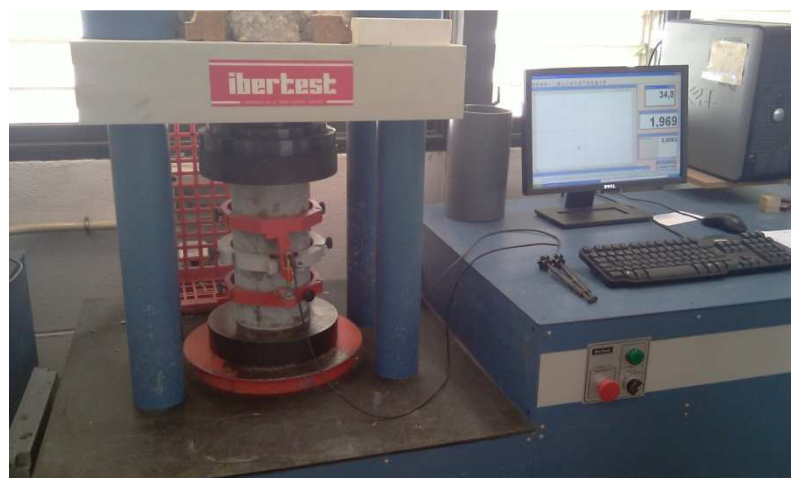
Fotografía 25: Probeta cilíndrica obtención del módulo de elasticidad a compresión.
