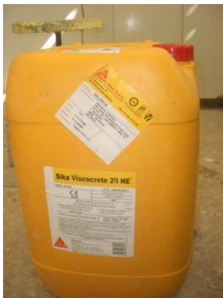
Fotografía 17: Aditivo superplastificante Sika Viscocrete 20HE.
