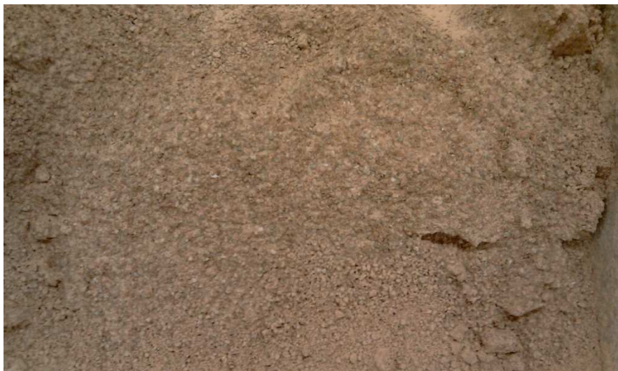
Fotografía 15: Arena gruesa 0/4, caliza rodada utilizada.
