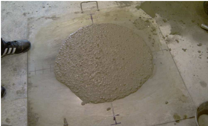
Fotografía 49: Propiedades del hormigón en estado fresco, ensayo del escurrimiento y T_{50} .
