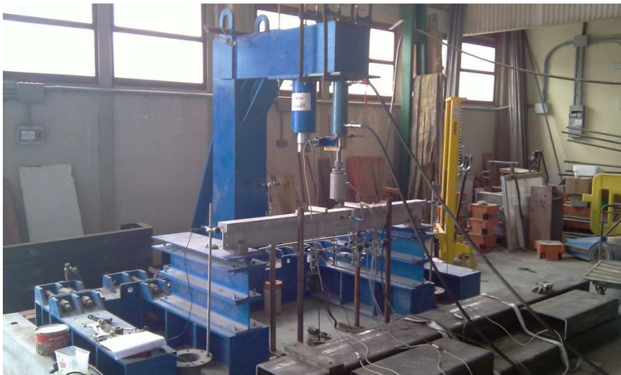
Fotografía 53: Viga híbrida ALB_HYB_HRF_0 patrón, ensayo a flexión en 4 puntos.
