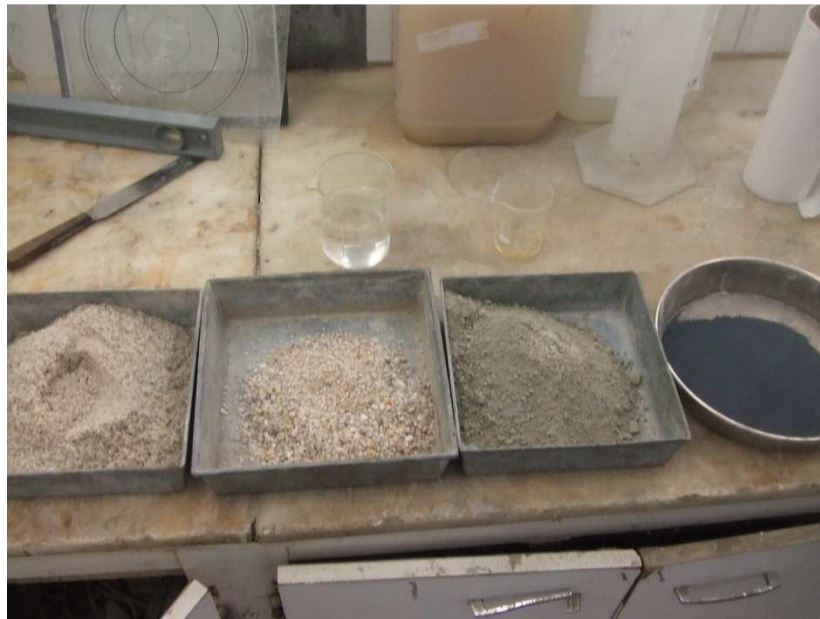
Fotografía 13: Materiales del hormigón de altas prestaciones utilizados.
