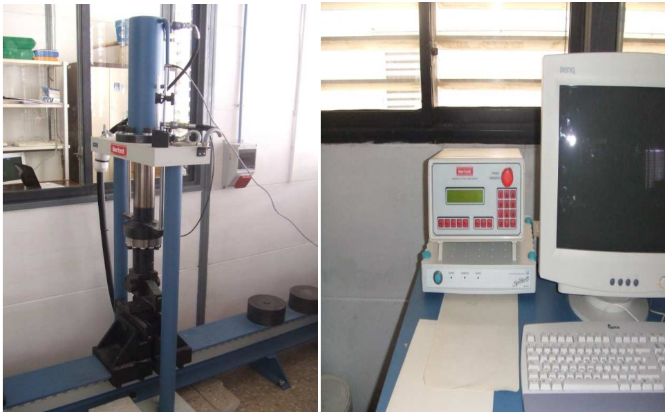
Fotografía 26: Máquina de ensayos a flexión del laboratorio del DCAR, ETSIE.
