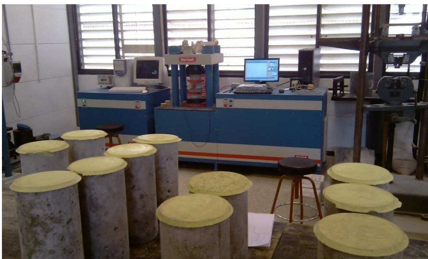
Fotografía 50: Serie de probetas para realizar ensayos de compresión a 28 días.
