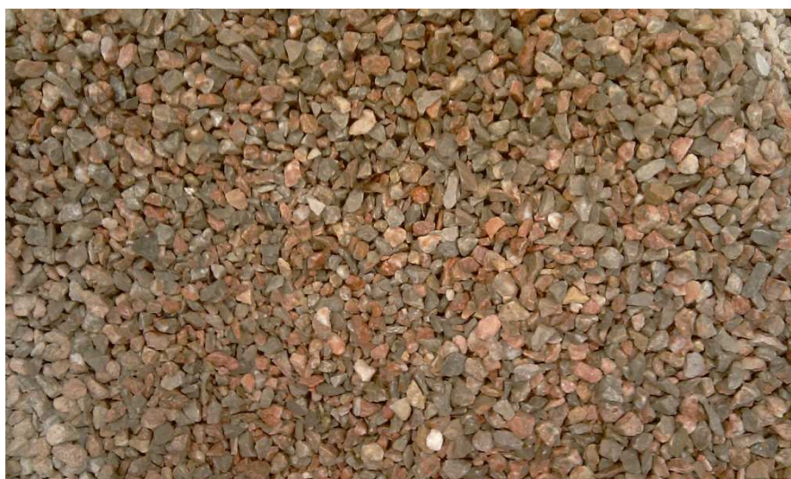
Fotografía 16: Grava 6/12, calizo machacado utilizado.
