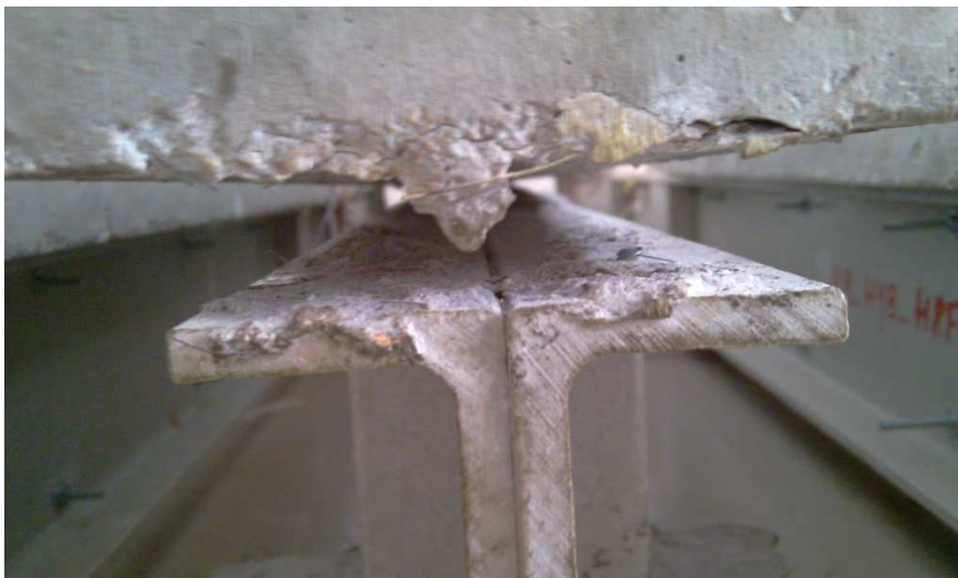
Fotografía 61: Rotura de los conectores en la viga híbrida ALB_HYB_HRF_60.
