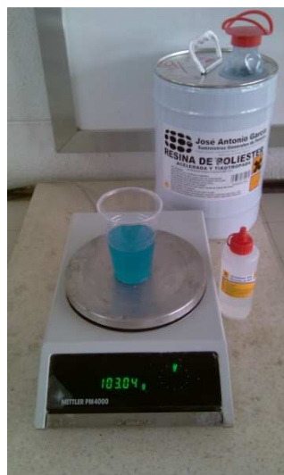
Fotografía 38: Dosificación de la resina de poliéster ortoftálica.
