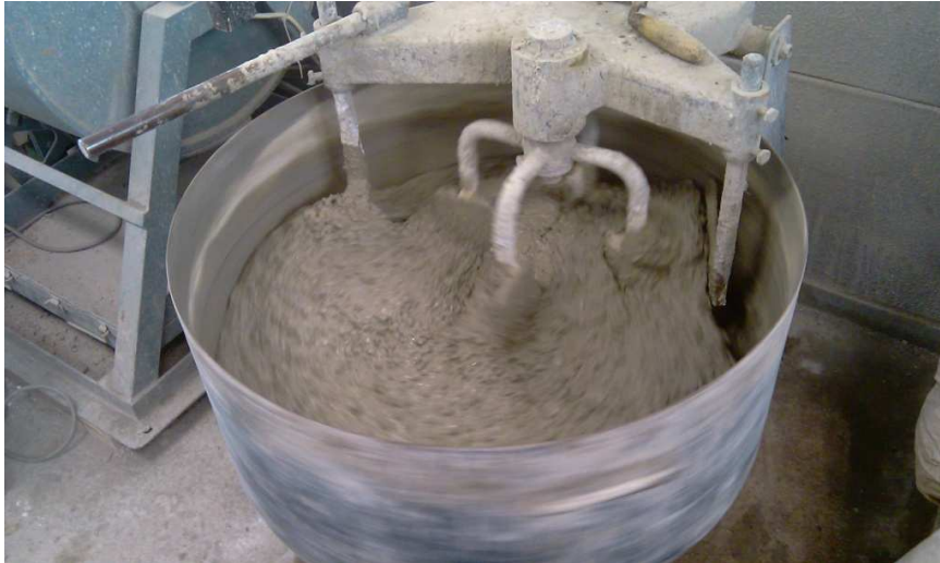
Fotografía 31: Amasadora hormigón de eje vertical.
