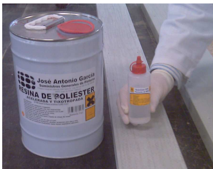
Fotografía 21: Resina de poliéster insaturado ortoftálico y el catalizador metil-etil-cetona, para unir las almas de los UPN pultrusionados de GFRP.
