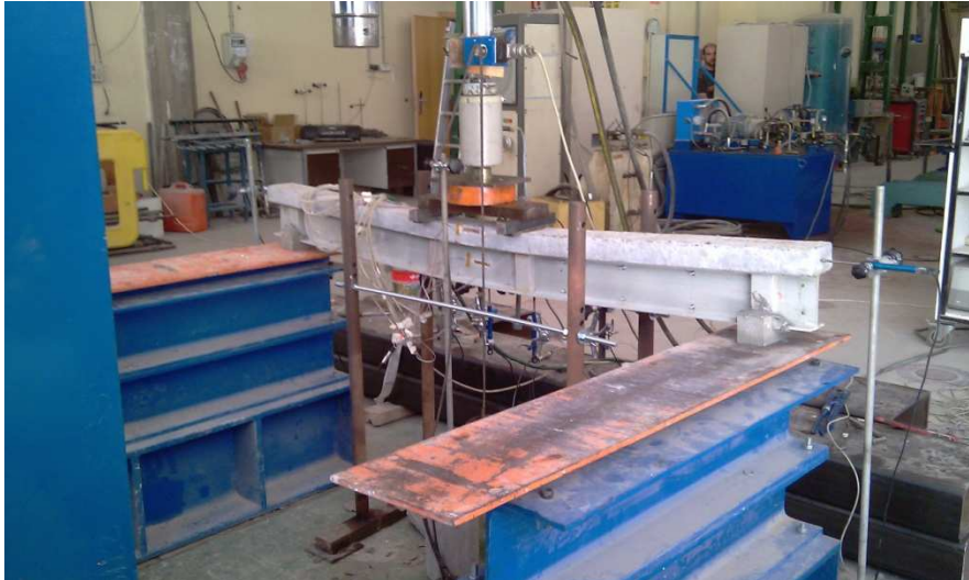
Fotografía 62: Viga híbrida ALB_HYB_HRF_120, ensayo a flexión en 4 puntos.
