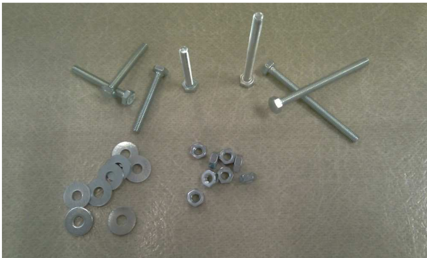
Fotografía 22: Tornillería de cabeza hexagonal métrica 4 mm, con arandelas y tuercas de 50 y 30 mm de caña
