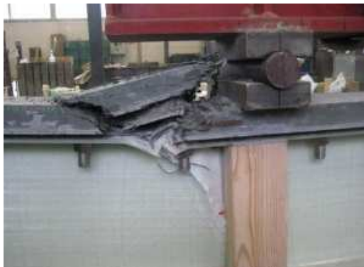
Figura 41: Aplastamiento del hormigón por esfuerzos normales.[7]
