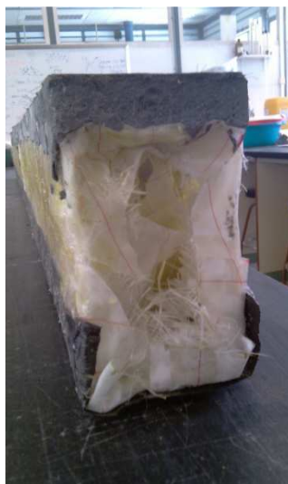
Fotografía 66: Viga híbrida de GFRP+CF+UHPC realizada mediante un proceso manual.
