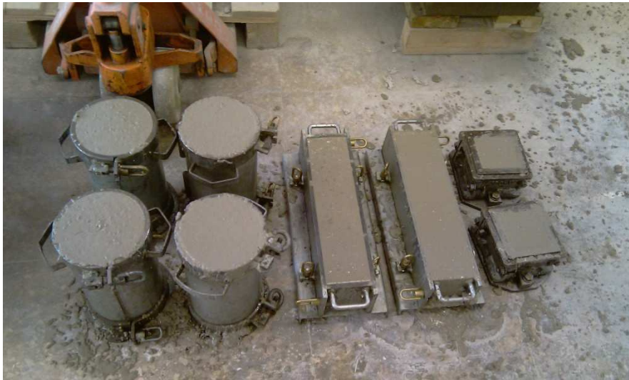
Fotografía 35: Llenado de probetas del HAC+HRF+HAR utilizadas en los ensayos de laboratorio.
