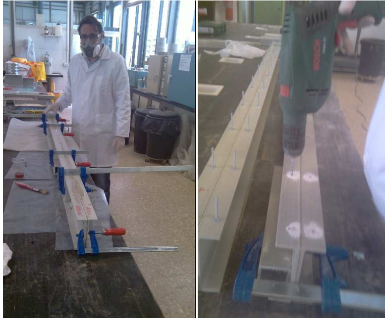
Fotografía 40: Unión de UPN por el alma (izquierda) y colocación de tornillos M4 a modo de conectores (derecha).
