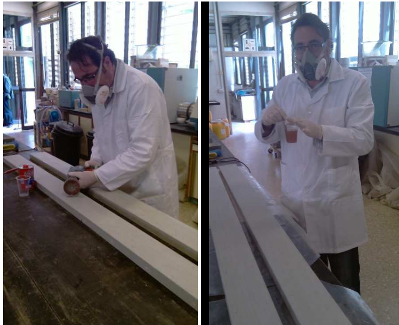
Fotografía 39: Lijado almas (izquierda) e impregnación con resina de poliéster del alma del perfil (derecha).
