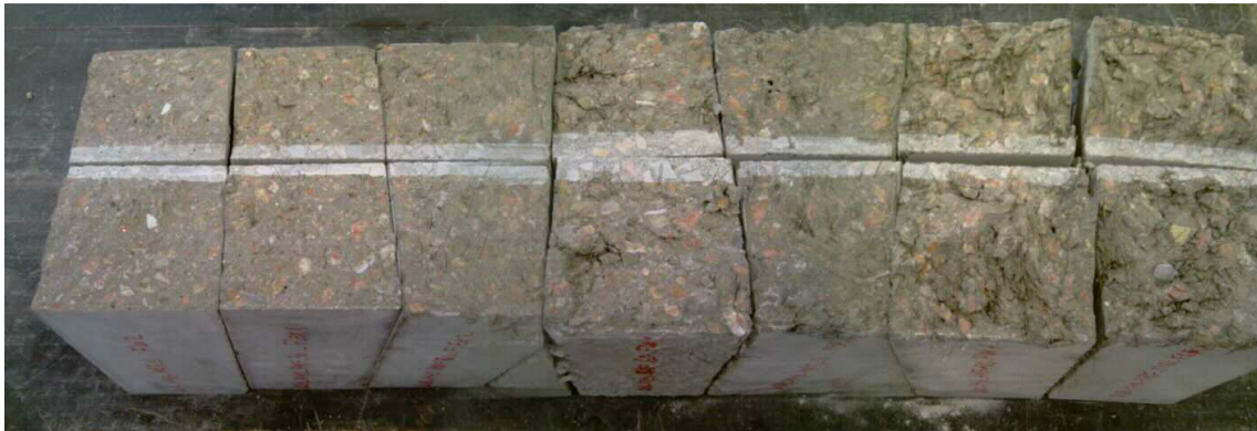
Fotografía 52: Probetas de los HRF tras la rotura a flexión en tres puntos a 28 días.
