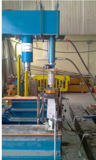
Fotografía 55: Viga híbrida ALB_HYB_HRF_30, ensayo a flexión en 4 puntos.
