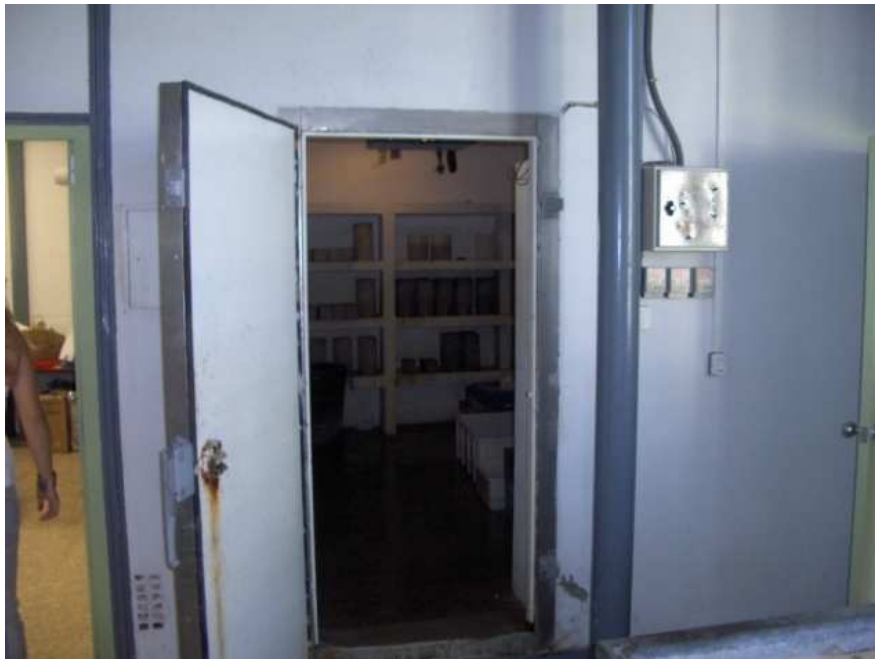
Fotografía 44: Cámara de curado utilizada a 24 °C y 100% HR.
