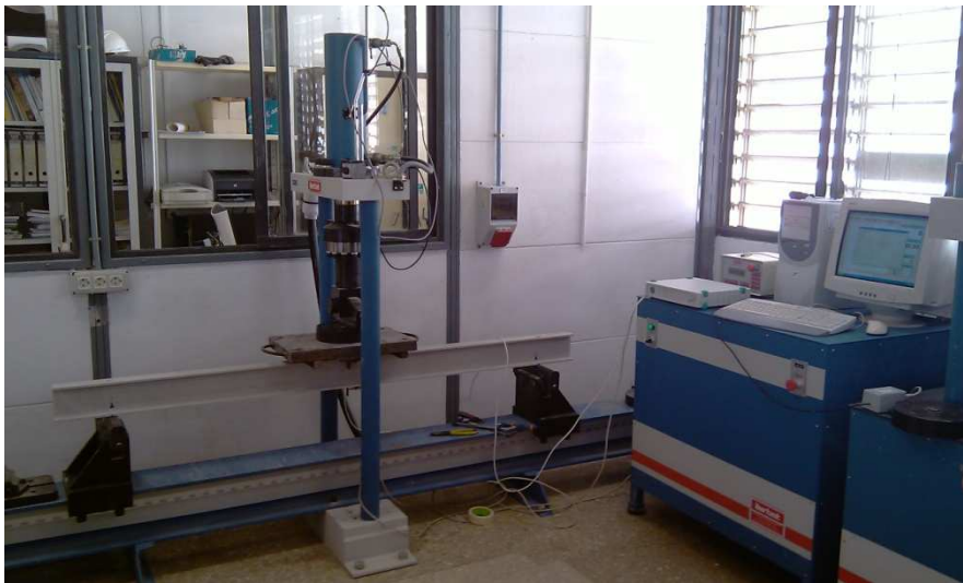
Fotografía 68: IPE-120 60 8 pultrusionado de GFRP.
