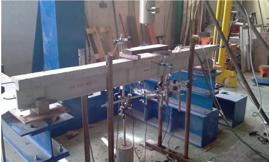
Fotografía 59: Viga híbrida ALB_HYB_HRF_60, ensayo a flexión en 4 puntos.
