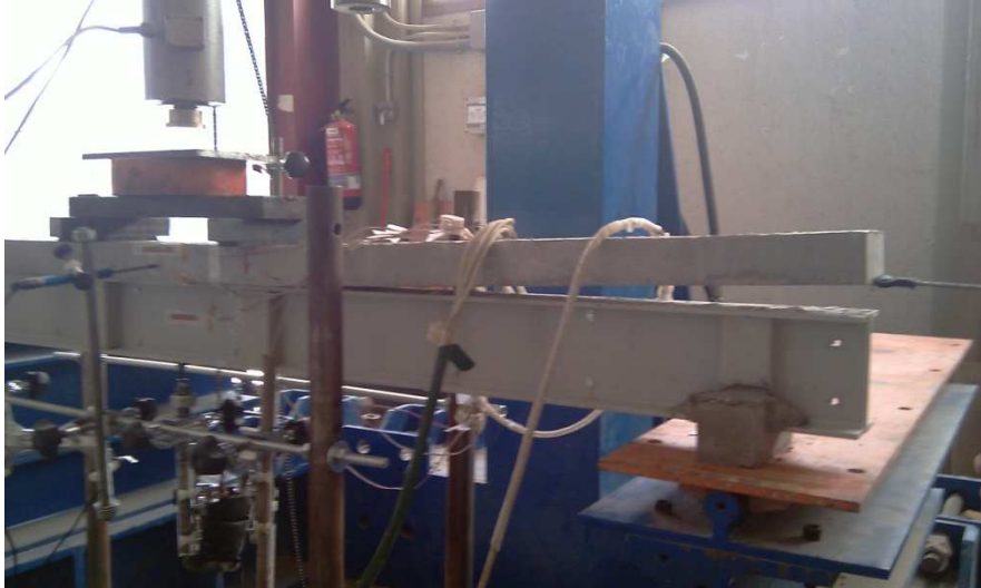
Fotografía 60: Rotura a flexión 4 puntos de la viga híbrida ALB_HYB_HRF_60.
