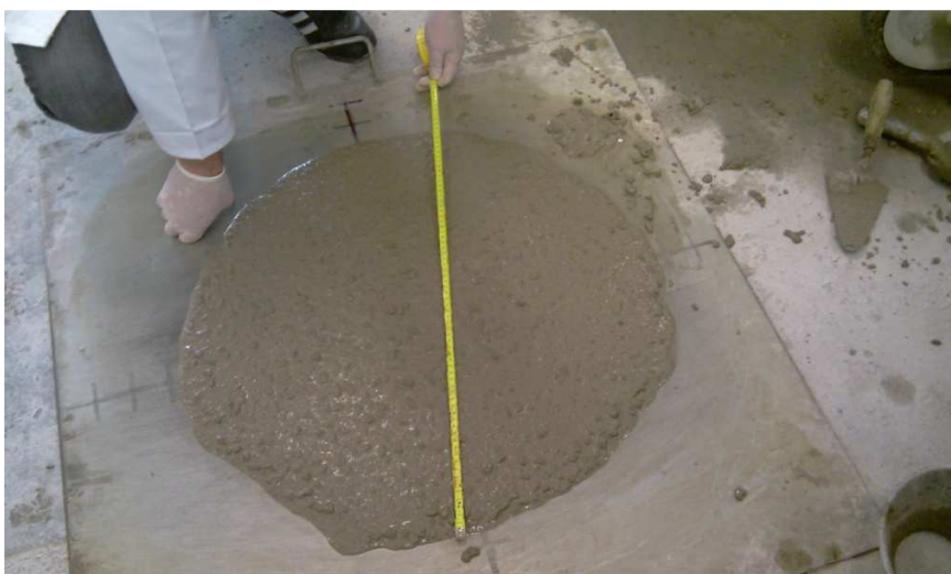
Fotografía 32: Medición del escurrimiento y el T_{50} del hormigón en los ensayos de laboratorio.
