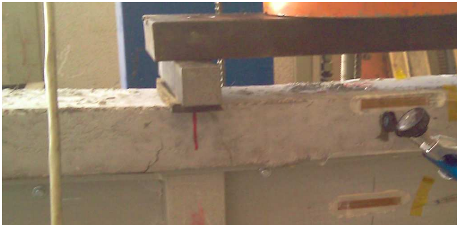
Fotografía 64: Rotura a flexión 4 puntos de la viga híbrida ALB_HYB_HRF_120.
