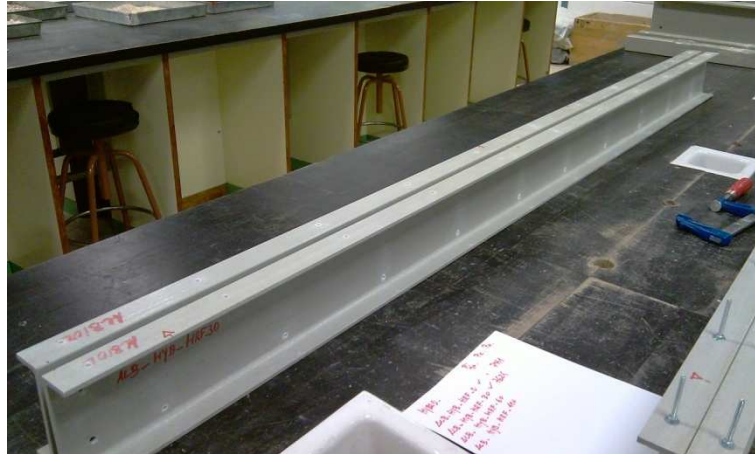
Fotografía 28: Perfiles UPN pultrusionados de GRFP utilizados.
