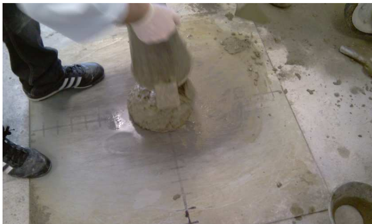
Fotografía 24: Ensayo escurrimiento en laboratorio.
