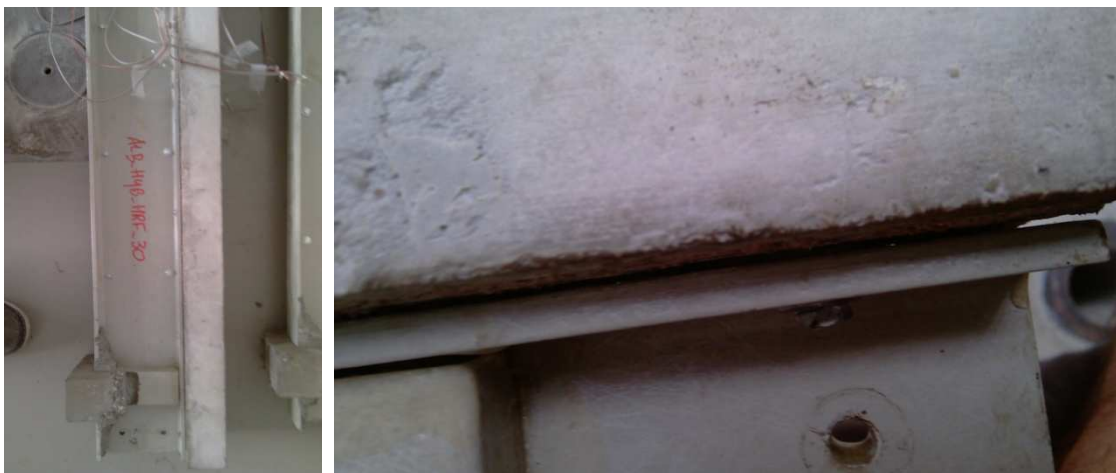
Fotografía 58: Rotura a rasante en el ensayo a flexión 4 puntos de la viga híbrida ALB_HYB_HRF_30.
