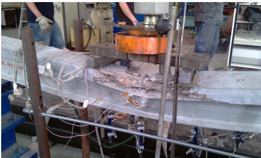
Fotografía 54: Rotura a flexión 4 puntos de la viga híbrida ALB_HYB_HRF_0 patrón.
