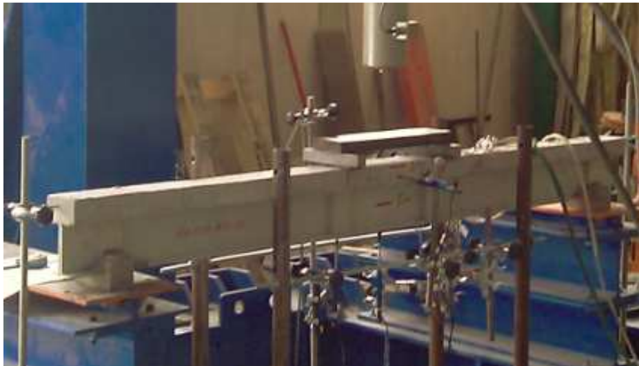
Fotografía 48: Colocación de los captadores de deformación en las vigas híbridas.
