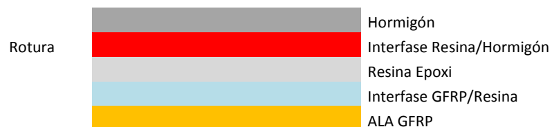
Figura 74: Esquema interfase GFRP/ Hormigón.
