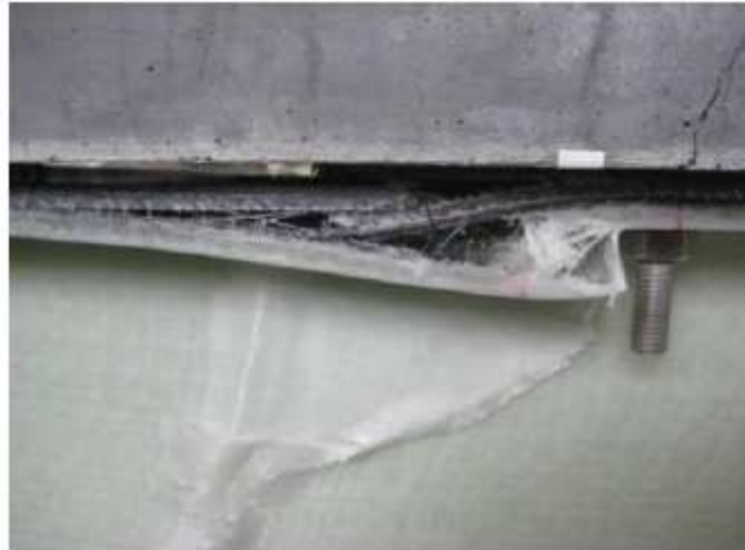
Fotografía 6: Ensayo viga polimérica, cortante y alabeo ala comprimida.[7]
