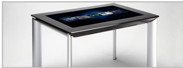
FIGURA 2.1: PixelSense 2.0, Samsung SUR40. Una pantalla de alta resolución con sensores integrados permite capturar imágenes de lo que hay sobre la pantalla. Internamente incorpora hardware de PC y un software que permite tratar estas capturas para interactuar con el sistema.
