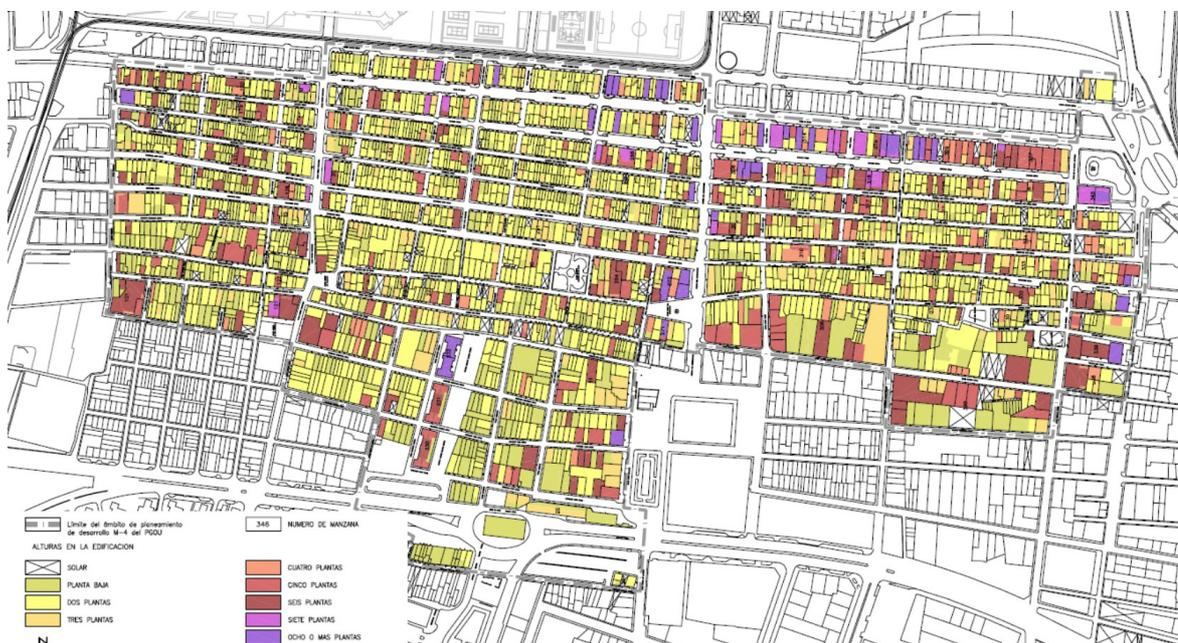
Figura 27: Plano de alturas de la edificación. (fragmento del plano de información plano 8 Alturas de la edificación del PEPRI)
