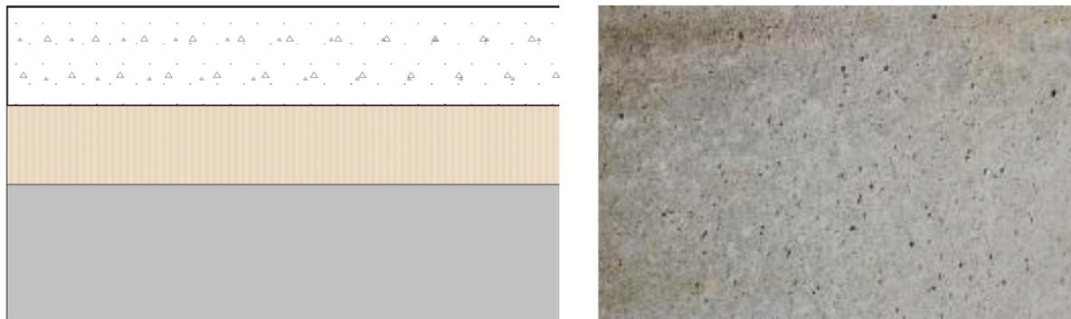
Debido al desgaste que puede estar sometido este tipo de pavimento por el uso que se le proporcionará optamos por un asfalto permeable (SUDS), este tipo de pavimento es altamente resistente y duradero. Se le aplicará un color rojo; típico de los carriles de bicicletas y éste tiene la condición de que es permeable, que en caso de inundación, fuertes lluvia, etc. el agua no permanecerá posada en la superficie.
