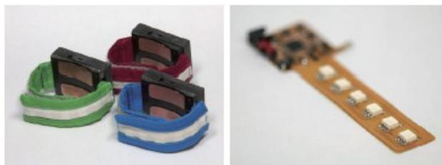
*Figura 2.7:Diseño del Dispositivo Tipo Pulsera*
