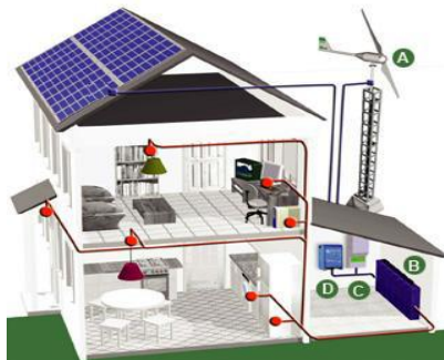
Figura 16. Componentes de instalación eólica. 2008. ( www.lacasasostenible.com / www.bornay.com ).
