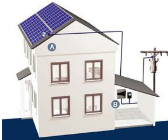
Figura 35. Esquema de instalación con balance neto. 2014. Wikipedia.
