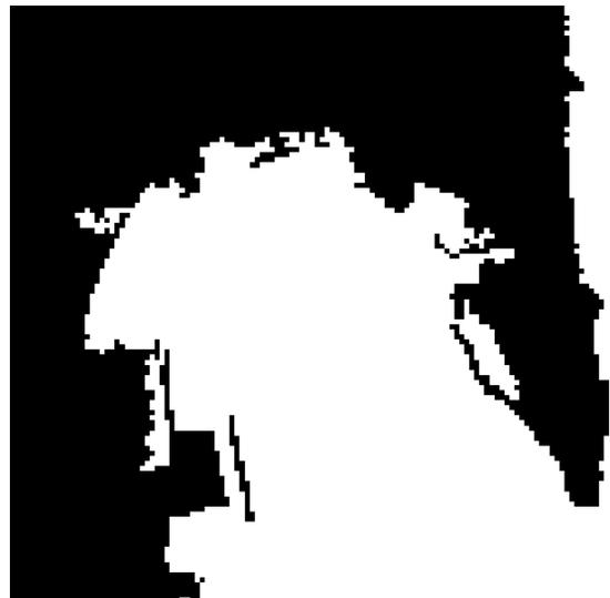
Figura 11. Máscara de tierra obtenida mediante la aplicación de la técnica multiresolución sobre la imagen de bordes.
