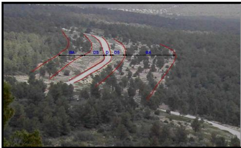
Imagen 7.8: Estructura de área cortafuegos apoyada en vial. D: banda de decapado (la constituye el propio vial); DS: banda de desbroce; BA: banda auxiliar. Fuente: Plan de Prevención de Incendios Forestales de la Demarcación de Xàtiva.
