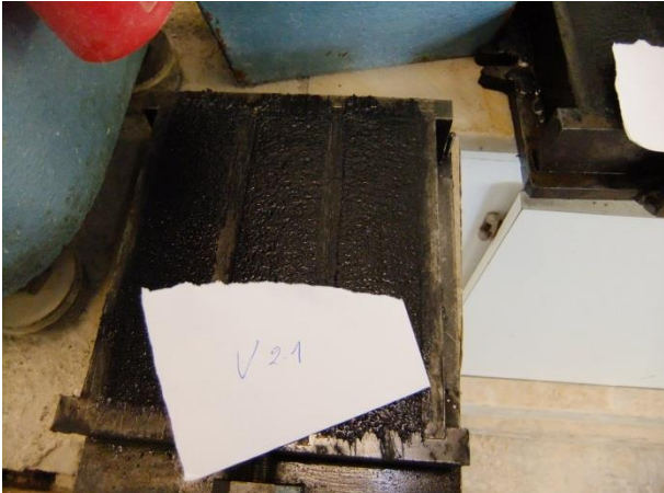
Imagen 4.1 – Mortero Cal/FC/CCA (20/50/30) – A/B 0,60 – 0% azúcar
