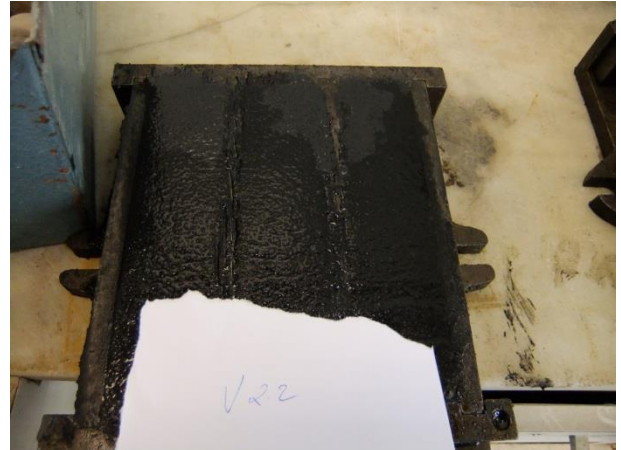
Imagen 4.2 – Mortero Cal/FC/CCA (20/50/30) – A/B 0,60 – 0,10% azúcar
