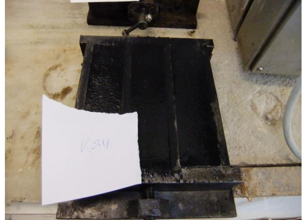
Imagen 4.4 – Mortero Cal/FC/CCA (20/50/30) – A/B 0,60 – 0,50% azúcar
