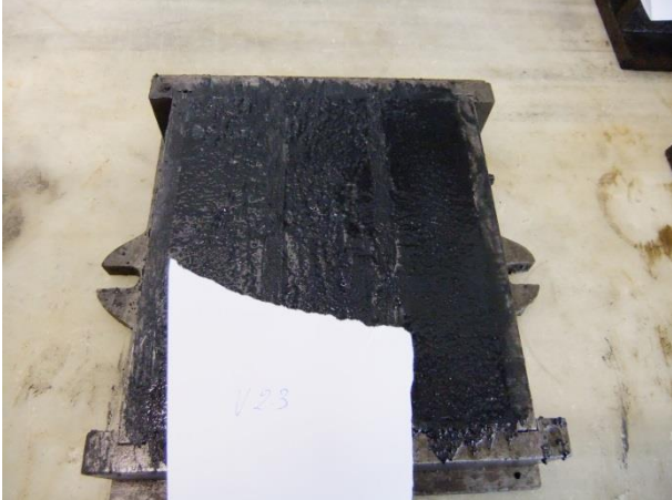
Imagen 4.3 – Mortero Cal/FC/CCA (20/50/30) – A/B 0,60 – 0,20% azúcar
