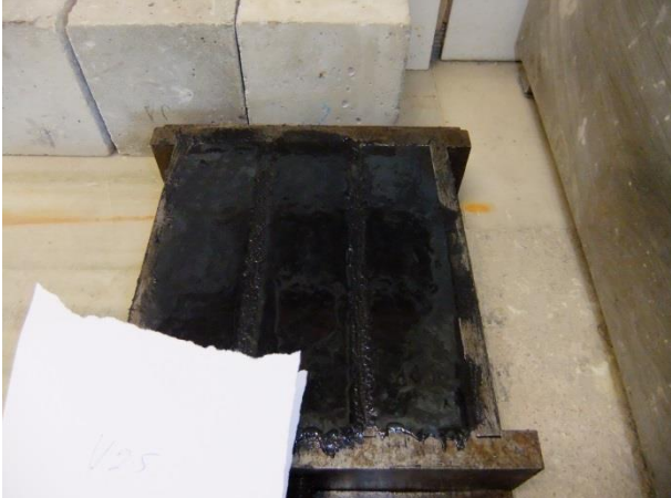
Imagen 4.5 – Mortero Cal/FC/CCA (20/50/30) – A/B 0,60 – 1,00% azúcar
