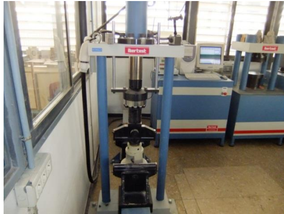
Imagen 3.9 – Equipo para ensayos de flexión y compresión
