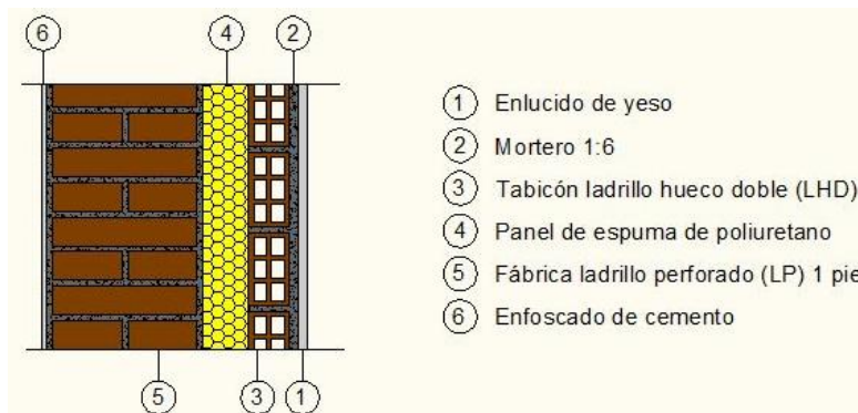
Ilustración 23. Detalle constructivo-Medianeras.2014.AutoCAD.
