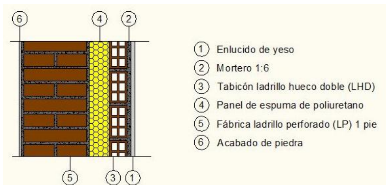
Ilustración 19. Detalle constructivo-Fachada principal-zonas no húmedas.2014.AutoCAD.
