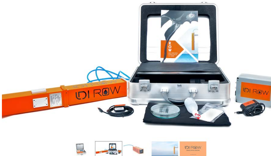
Figura 2.- Equipo completo de medidor de aceites remoto ROW, el espesor medio de una mancha de aceite es de 0,1 mm, mientras que ROW puede detectar algunos aceites a sólo 0,001 mm. (Fuente: [14])
