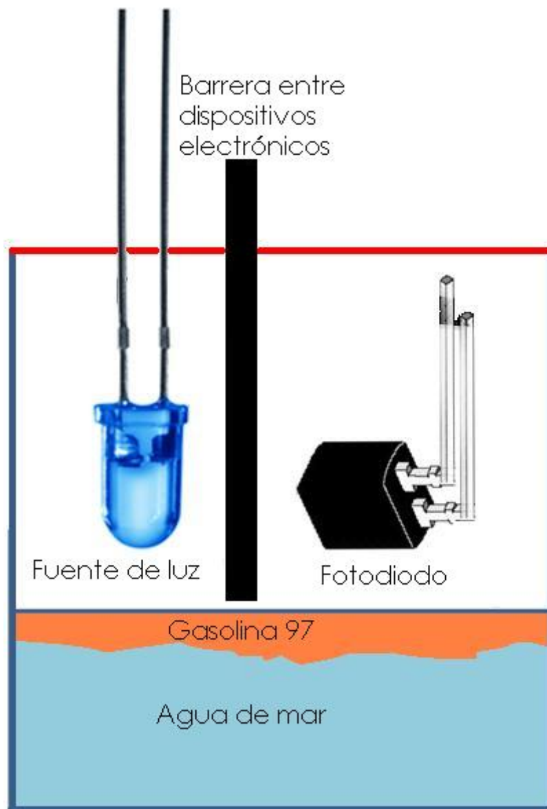
Figura 12.- Disposición grafica del prototipo, la fuente de luz emitirá directamente sobre el líquido y el fotodiodo se encontrara instalado de tal manera que la cara que recibe energía estará paralela al líquido.
