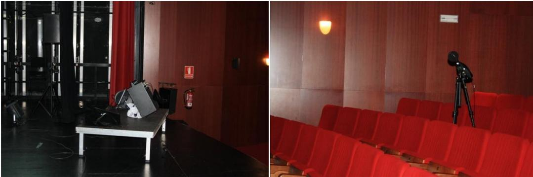
Figura 20. Colocación fuente y micrófono
