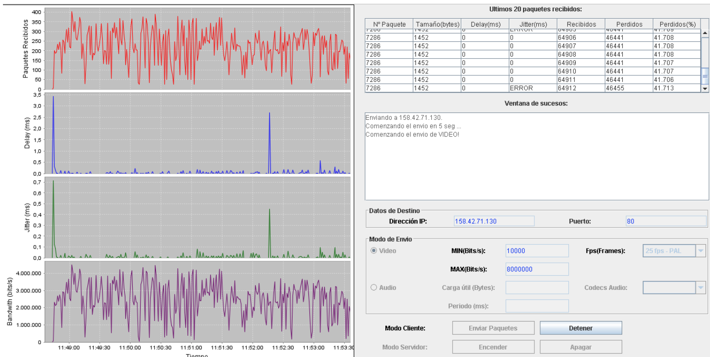
Figura 16. Gráfica de emisión sobre HTML5 en PAL 25 del vídeo comprimido en MP4
