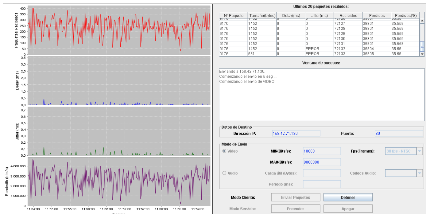
Figura 17. Gráfica de emisión sobre HTML5 en NTSC 23,976 del vídeo comprimido en MP
