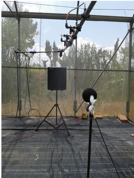
**Figura 8.** Disposición de los elementos del sistema de inyección de agua.
