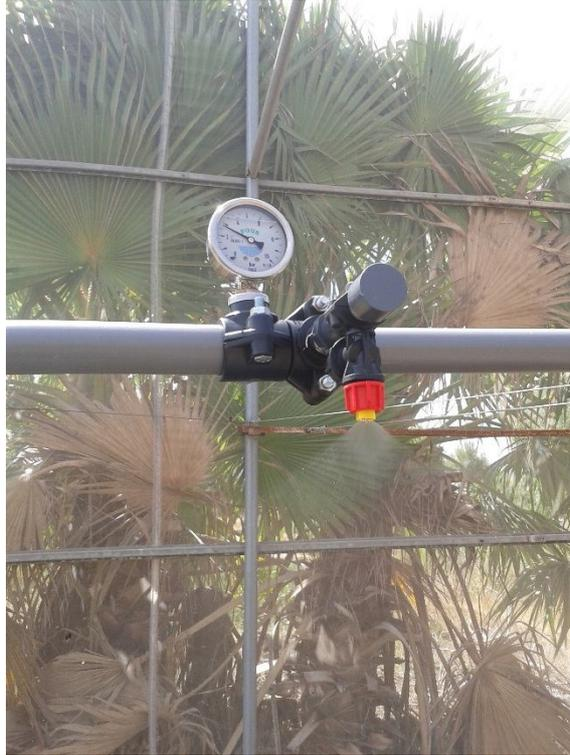
**Figura 7.** Ángulo de apertura de  $110^\circ$  formado por los difusores.
