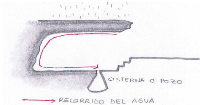
Figura 56, filtración de agua de lluvia en una casa cueva(2014). Fuente: Imagen de autor
