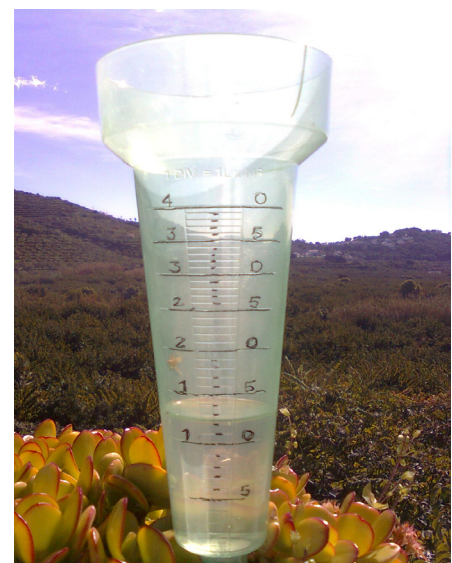
Figura 73, Pluviómetro. Cada milímetro de agua contenida en el vaso del pluviómetro equivale a 1 litro por metro cuadrado (2014)
