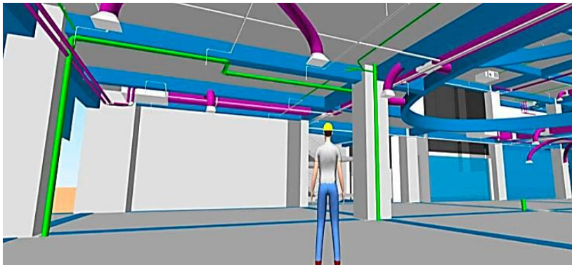
Figura 19 Recorrido Virtual con Naviswork®. 2011. Fuente: “Detección de interferencias e incompatibilidades en el diseño de proyectos de edificaciones usando tecnologías BIM.” (Taboada García et al.)
