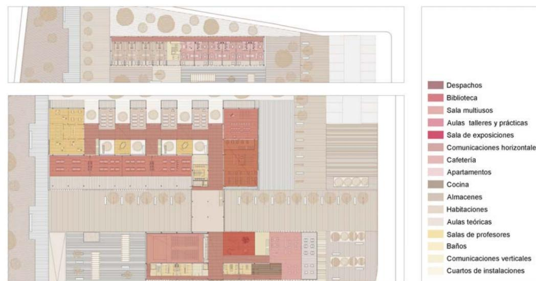
Esquema de usos de la universidad. Planta baja y planta primera
