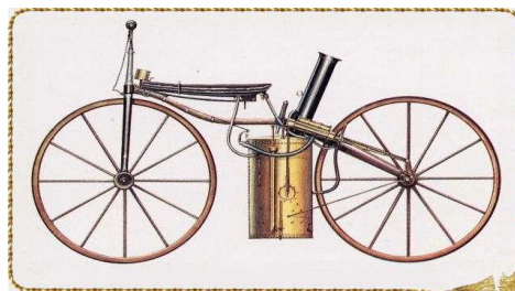
Figura 1: Motocicleta accionada por motor a vapor de Sylvester Howard
