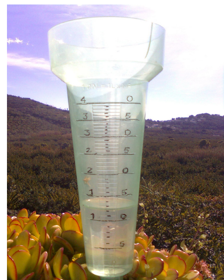
Figura 72, Pluviómetro. Cada milímetro de agua contenida en el vaso del pluviómetro equivale a 1 litro por metro cuadrado (2014)
