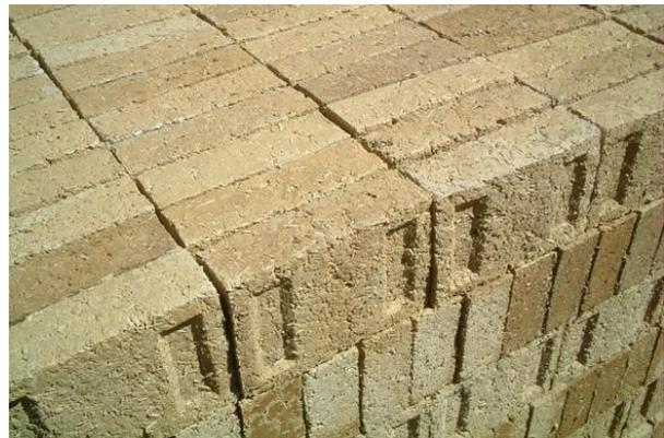
Imagen 13. Bloque estructural aislante de cáñamo
