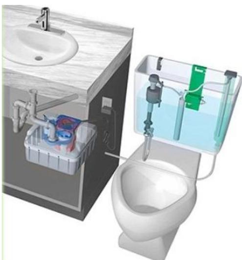
Figura 14. Sistema de reciclado de aguas grises localizado
