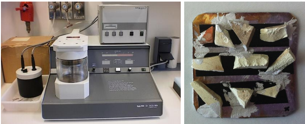
Recubridor BAL-TEC SCD005 / Ejemplo preparación portamuestra, previo "sputtering"
