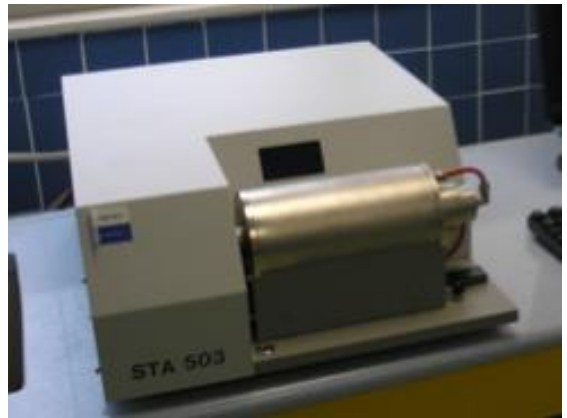
FRX, PHILIPS modelo Magix 648 / ATD/TG simultáneo BÄHR, STA503
