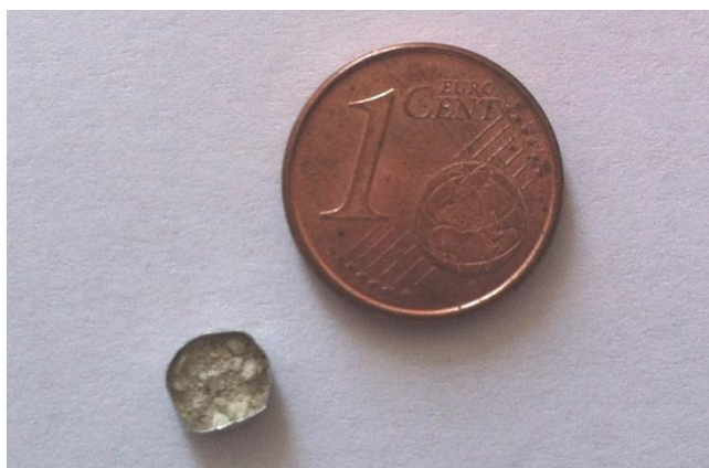
Crisol de platino de 50 \mu L para ATD/TG
