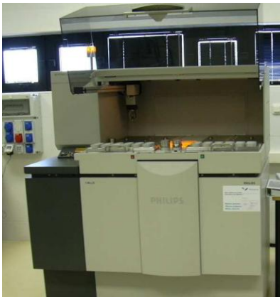
FRX, PHILIPS modelo Magix 648 / ATD/TG simultáneo BÄHR, STA503
