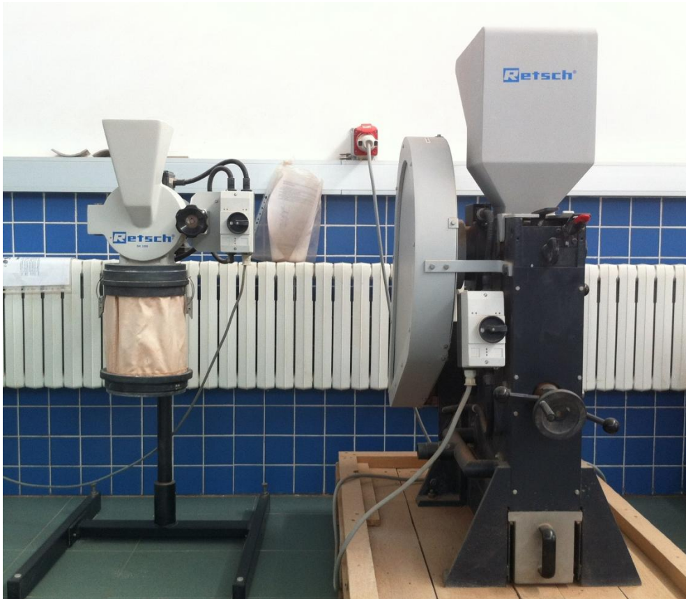
Molino de martillos y tamiz de 1mm. Molino de mandíbulas de apertura 5mm
