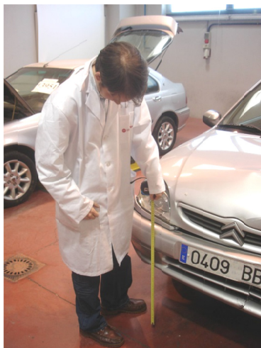
Figura 2: Verificación de la altura de los daños producidos
