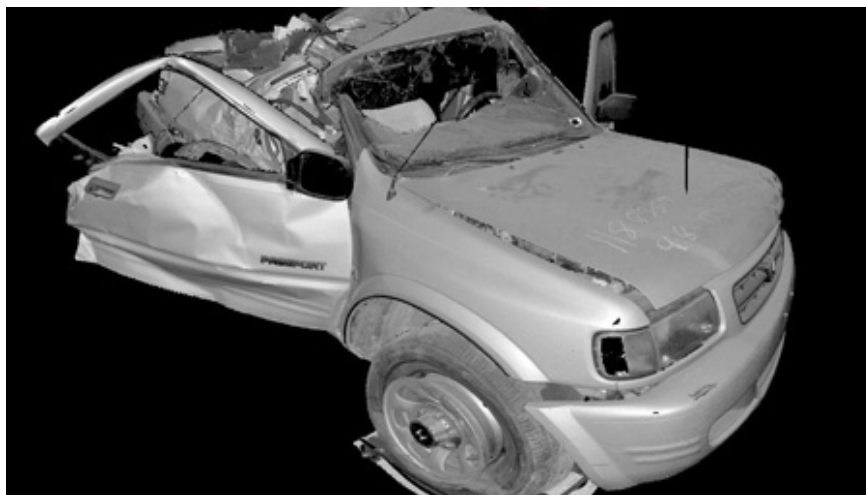
Figura 4: Modelización con escáner 3D de un vehículo siniestrado
