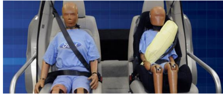
Figura 9: Airbag de cinturón diseñado por Ford Motors.
