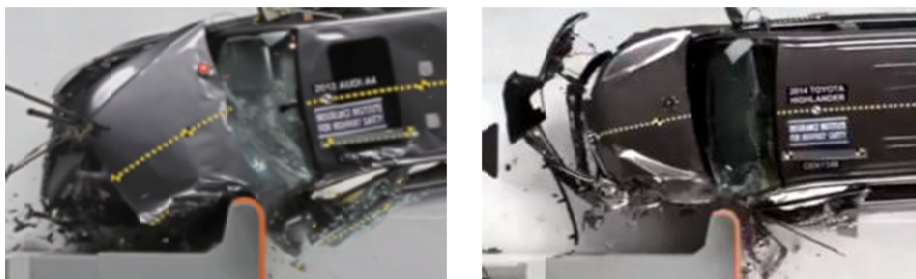
Figura 11: Ejemplo del comportamiento distinto ante el ensayo de smalloverlap . A la izquierda absorción de energía y a la derecha desvío de trayectoria.
