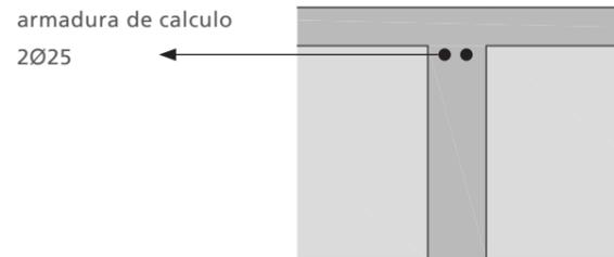
ARMADO SECCIÓN 1 (M = 340 kN\*m)
