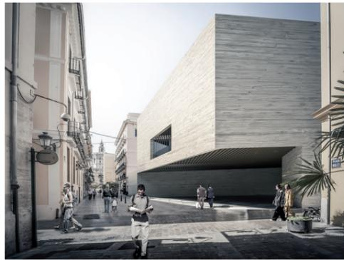
Elegimos una estructura muraria, de hormigón armado. Su apariencia final será de hormigón entablillado con maderas en sentido horizontal. Queremos conseguir con esto un aspecto pétreo buscando siempre la imagen de la referencia de Chillida.
