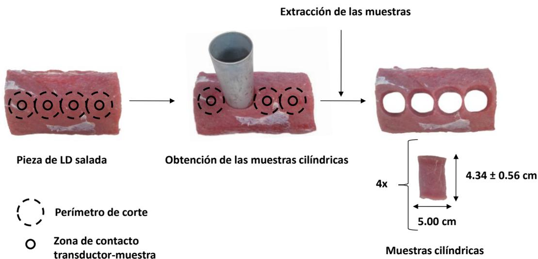
**Figura 3.4. Proceso de obtención de las muestras saladas cilíndricas.**
