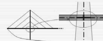
Nudo rígido entre tablero y pilono
