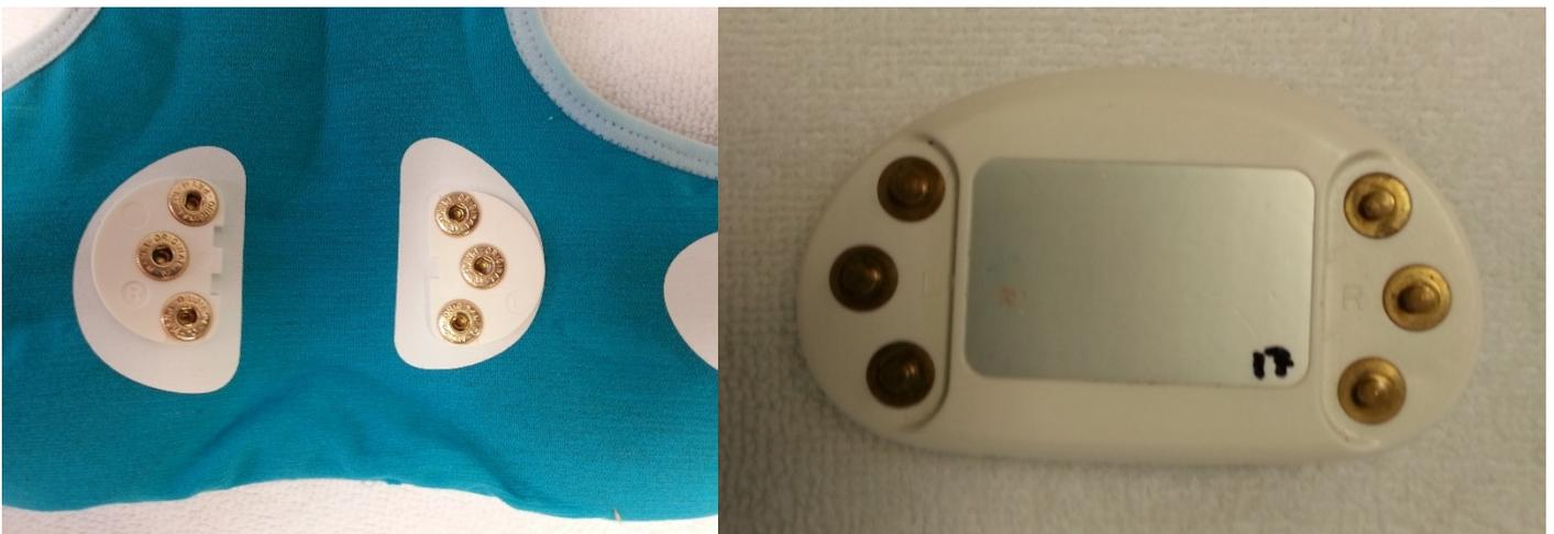
Figura 4.73 Detalle del conector de la banda al dispositivo de Nuubo.
