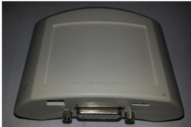
Figura 3.14 Foto del encapsulado con las ranuras realizadas.
