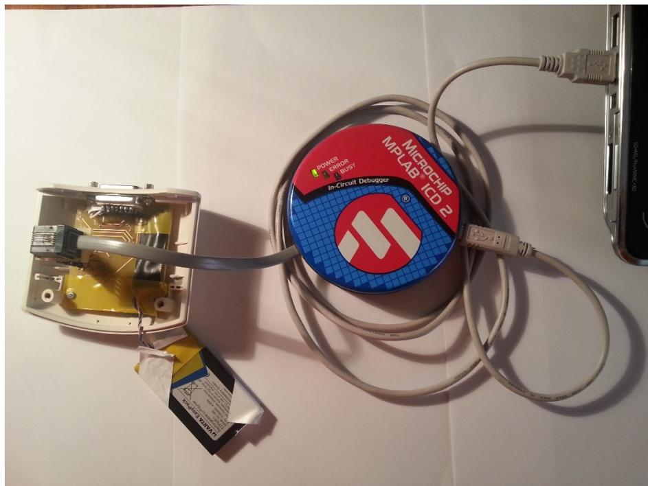
Figura 8.1 Conexión de la herramienta ICD2.
