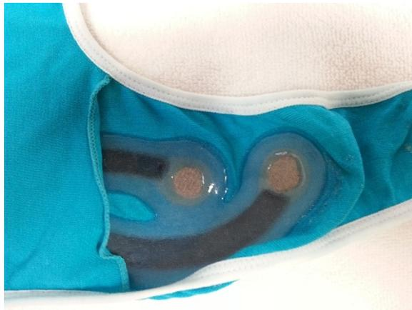
Figura 4.72 Detalle de los electros de la banda.
