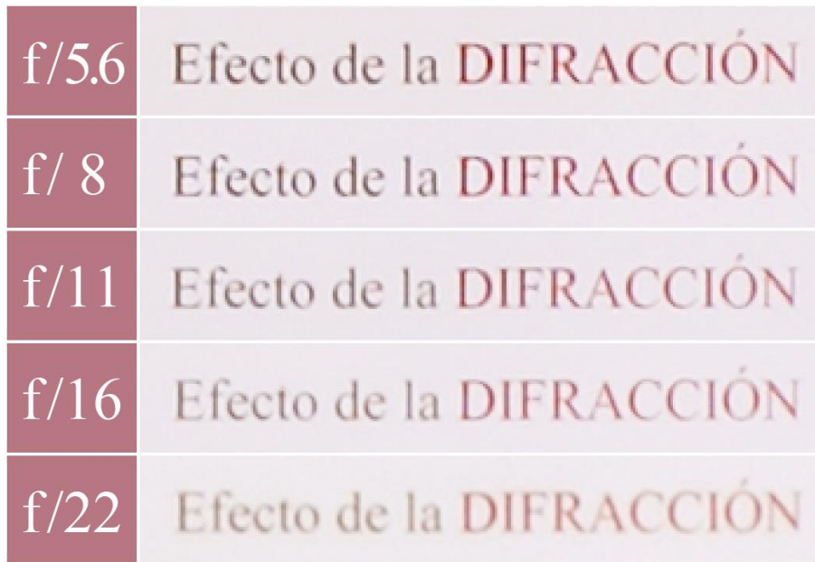
Fig. 10.3. Efecto de la difracción. Recorte ampliado de fotografías realizadas con una cámara Réflex con sensor APS-C. Pedro Cabezos
