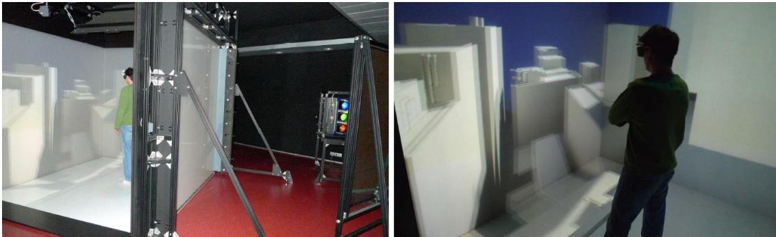
Fig. 11.18. Sistema CAVE de realidad virtual. Vista desde el exterior con los proyectores (izda.) y vista interior del recinto (dcha.). (Sáiz et al, 2010)
