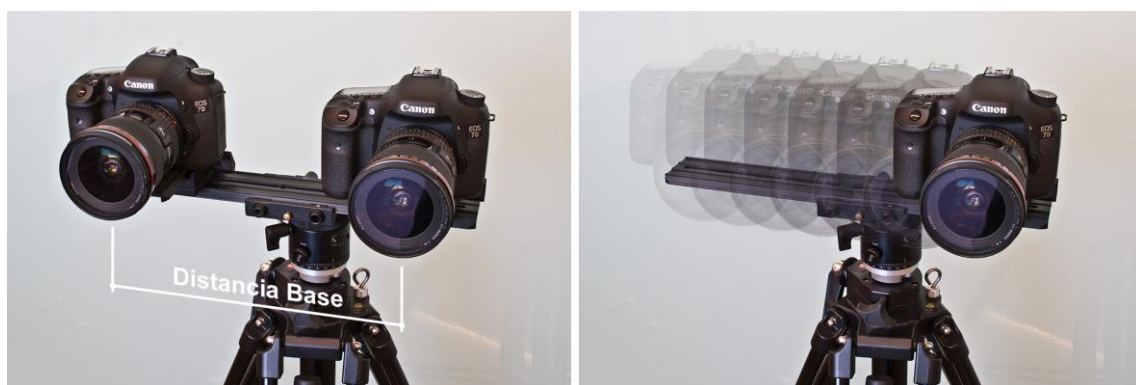
Fig. 9.6. Trípode y rail con dos cámaras para disparo sincronizado (izda.) y con una sola cámara para disparo alterno (dcha). Pedro Cabezos
