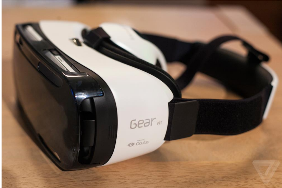
Fig. 11.21. Visor personal diseñado por Óculus que utiliza un Smartphone como pantalla
