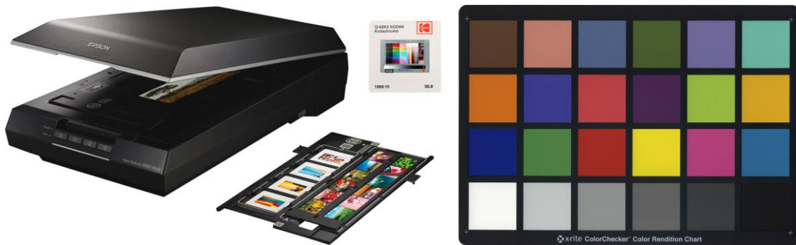
Fig. 14.8. Escáner y cartas de calibración empleadas
