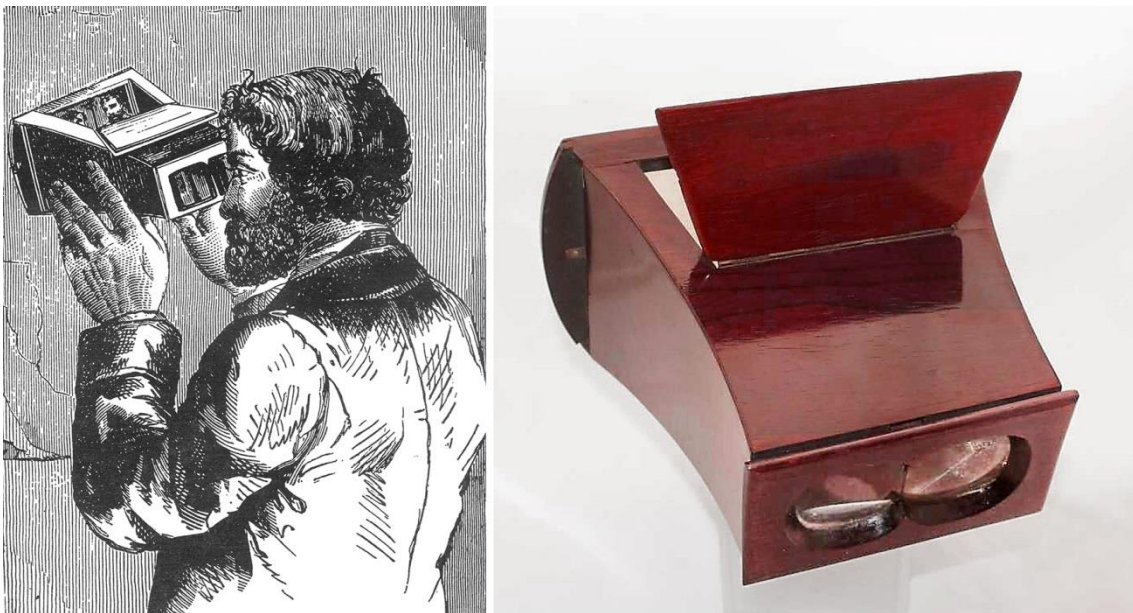
Fig. 7.9 Grabado de un estereoscopio tipo Brewster (Drouin, 1894). Fotografía de estereoscopio tipo Brewster ca. 1860
