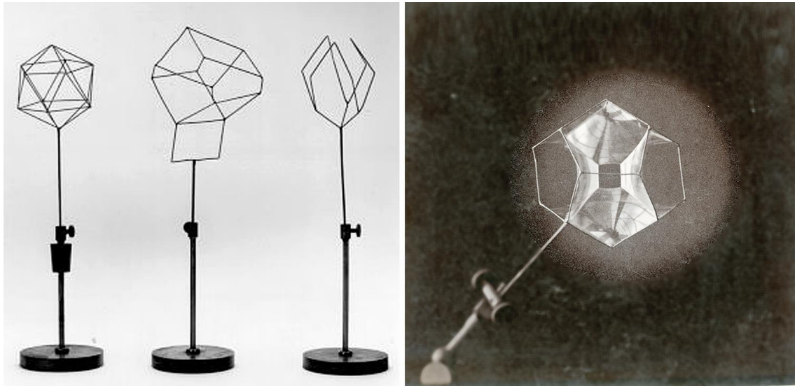
Fig. 15.10. Estructuras de alambre y superficie laminar formada al sumergirlas en glicerina líquida Copyright Museum for the History of Sciences, Ghent University
