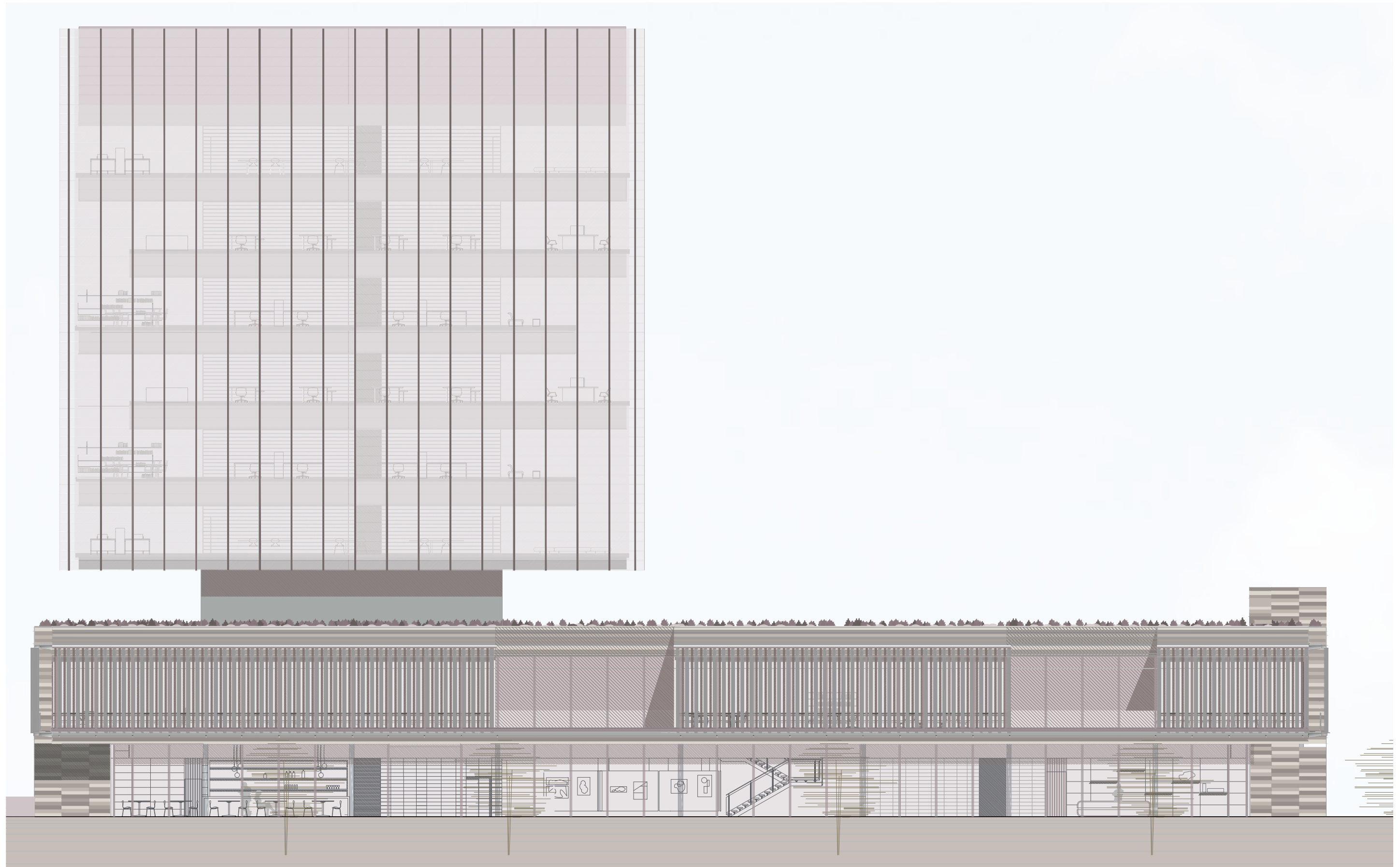
ALZADO OESTE CON PROTECCIÓN SOLAR E: 1/200
