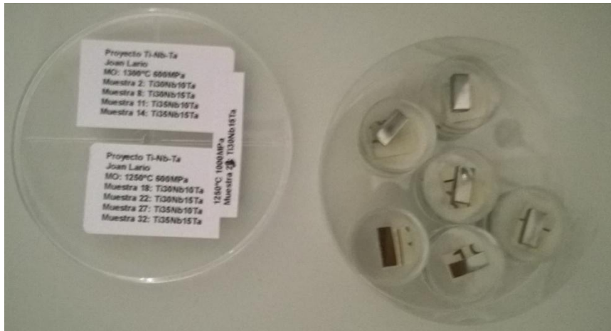
Ilustración 23: Muestras embutidas y pulidas para microscopía. Fuente: Elaboración propia.
