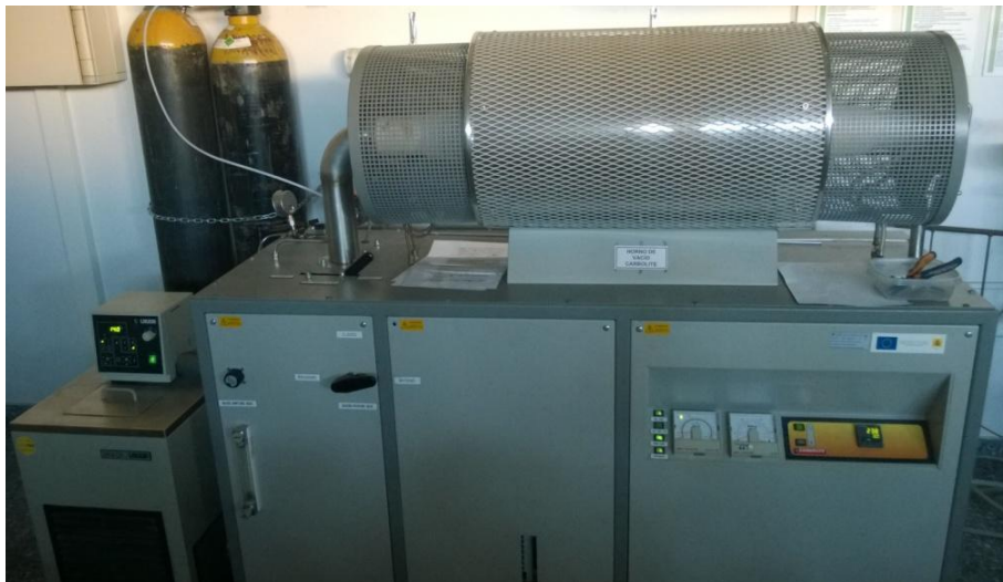
Ilustración 33: Horno Carbolite de alto vacío modelo HVT 15/75/450. Fuente: Elaboración propia.
