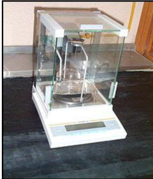
Ilustración 18: Balanza para medida de la densidad (Método Arquímedes). Fuente: Elaboración propia.
