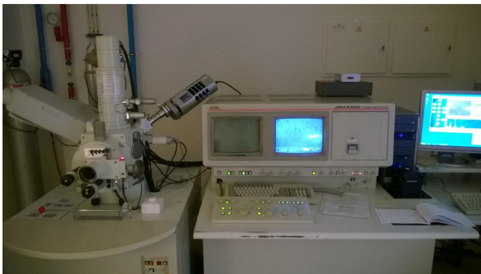
Ilustración 24: Microscopio Electrónica de Barrido (SEM) JEOL JSM 6300. Fuente: Elaboración propia.
