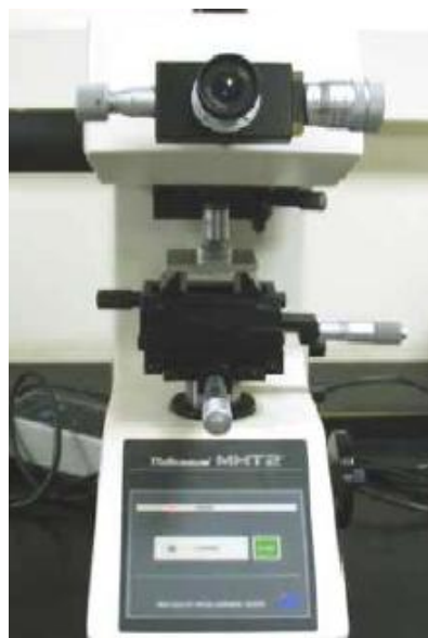
Ilustración 28: Microdurómetro Matsuwa MHT2 Fuente: Elaboración propia
