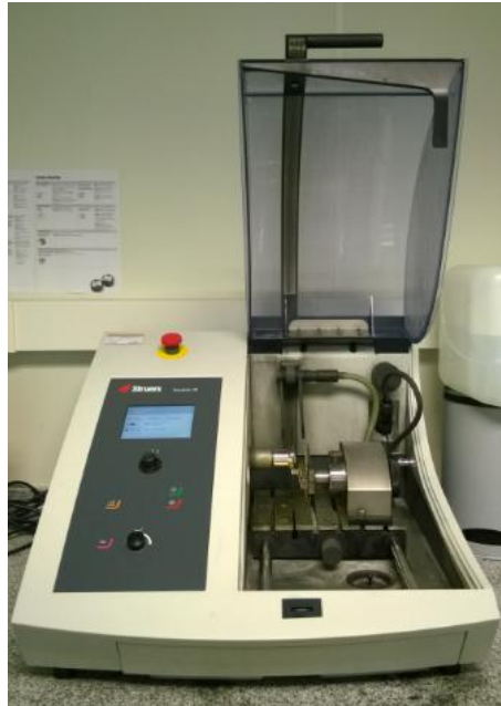
Ilustración 19: Cortadora de precisión Struers. Fuente: Elaboración propia.
