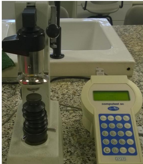
Ilustración 27: Durómetro portátil Ernst Computest sc. Fuente: Elaboración propia.
