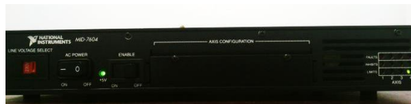
Figura 3.23 Motor paso a paso National Instruments MID- 7604. Permite hasta 4 ejes.
