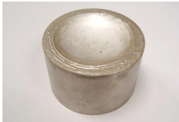
Figura 3.7 Unión de la carcasa exterior con la cerámica.
