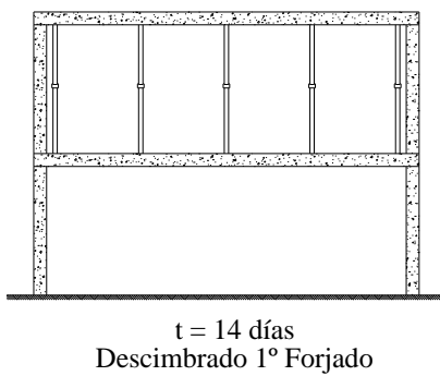
Fig. 4.6 Proceso constructivo día “14”
