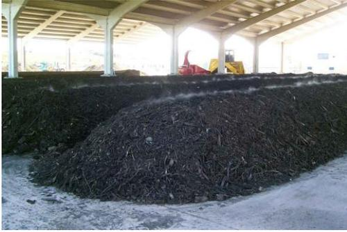
*Figura 17: Planta de compostaje de los fangos procedentes de las EDAR*
