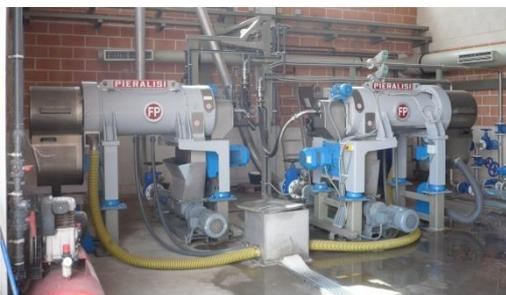
Figura 13: Decantadoras centrífugas
