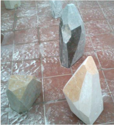
S'escata la pedra amb diferents granulatges d'abrasius.
