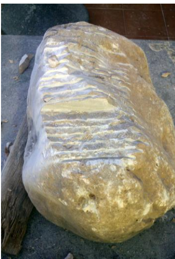
Desbast de la pedra amb la radial i el cisell.
