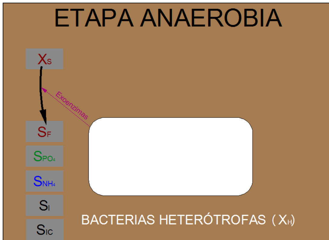
FIGURA 3. Esquema del proceso de hidrólisis contemplado para las bacterias heterótrofas durante la etapa anaerobia. (Elaboración propia)
