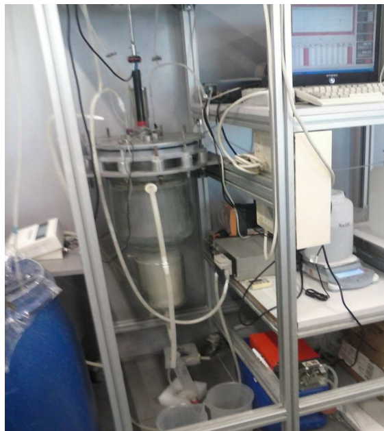
Ilustración 5. Disposición del reactor, bombas, sondas y conexión al PC.
