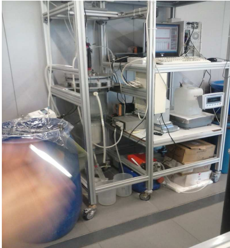
Ilustración 6. Reactor de precipitación y elementos auxiliares necesarios.
