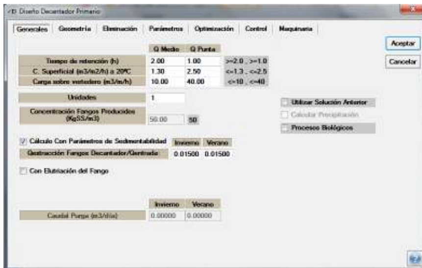
Figura 3.9. Pestaña de generales de la ventana de diseño de un decantador primario en el programa de simulación DESASS.
