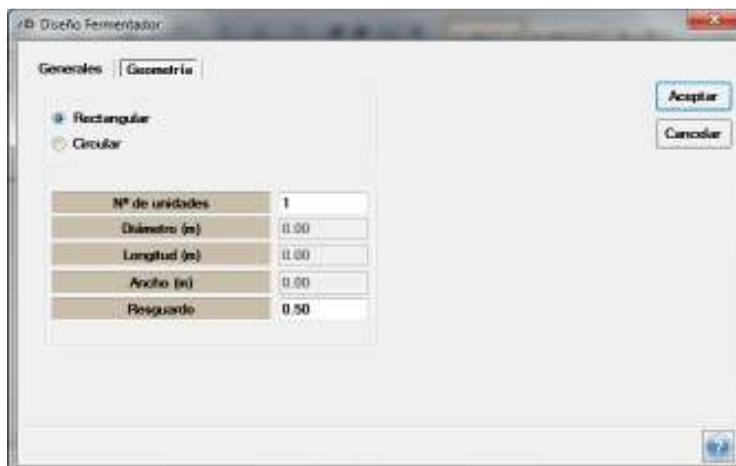
Figura 3.22. Pestaña de geometría de la ventana de diseño de un fermentador en el programa de simulación DESASS.
