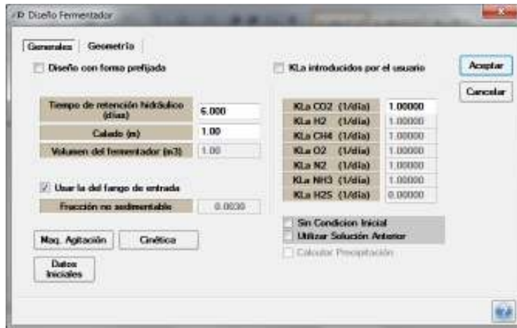
Figura 3.21. Pestaña de generales de la ventana de diseño de un fermentador en el programa de simulación DESASS.
