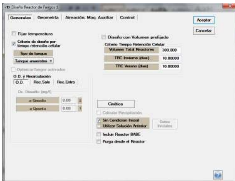
Figura 3.13. Pestaña de generales de la ventana de diseño de un módulo de reactor biológico en el programa de simulación DESASS.
