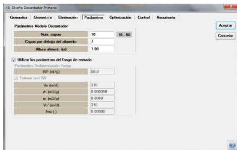
Figura 3.11. Pestaña de parámetros de la ventana de diseño de un decantador primario en el programa de simulación DESASS.
