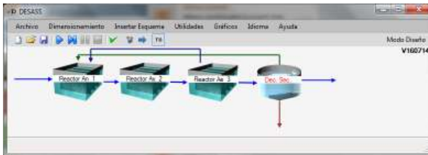
Figura 3.16. Esquema completo de un decantador secundario ejemplo en el programa de simulación DESASS.
