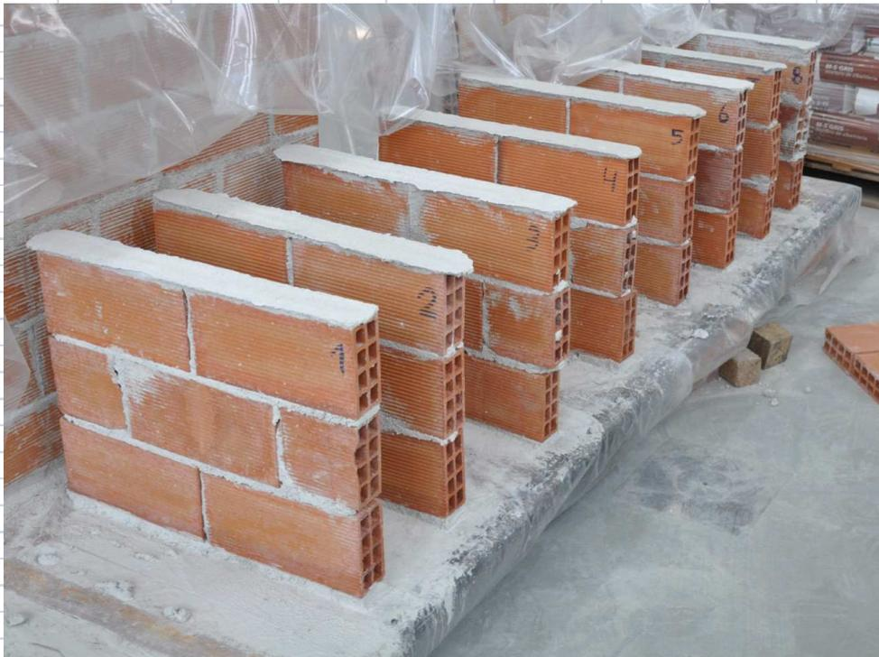
Especímenes tras el curado antes de ensayo
