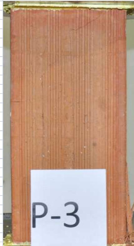
Se ha producido una rotura generalizada en todo el ladrillo. El refrentado consiste en una capa uniforme de azufre de espesor aproximado de 3 mm.
