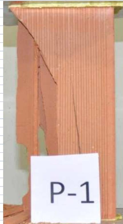
Se ha producido una rotura de la en ambas caras verticales con el desprendimiento de la la mitad del lateral izquierdo. El refrentado consiste en una capa uniforme de azufre de espesor aproximado de 3 mm.
