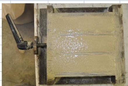
Ejecución de probetas mediante molde normalizado
