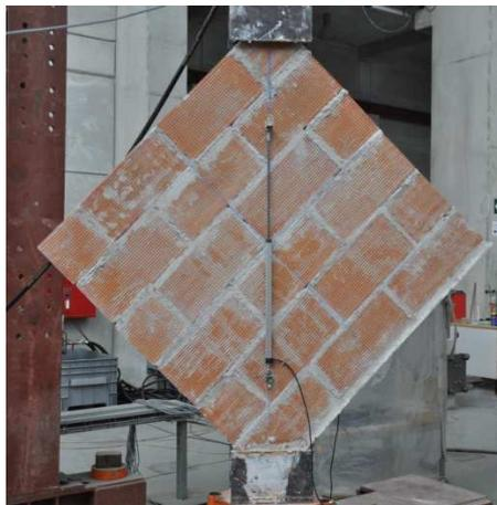
*Figura 27: Ensayo a compresión diagonal de la fábrica*
