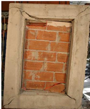
*Figura 61: Modo de fallo relleno Ensayo III*
