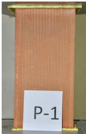
*Figura 32: Ensayo a compresión ladrillo posición vertical*
