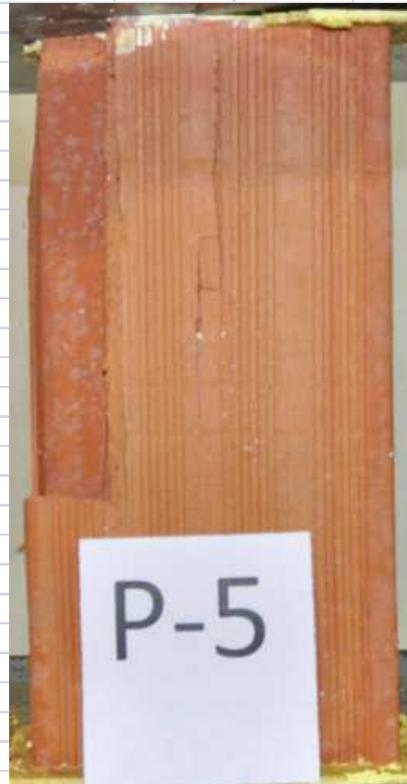
Se ha producido una rotura de la en ambas caras verticales con el desprendimiento de la la mitad del lateral izquierdo superior. El refrentado consiste en una capa uniforme de azufre de espesor aproximado de 3 mm.
