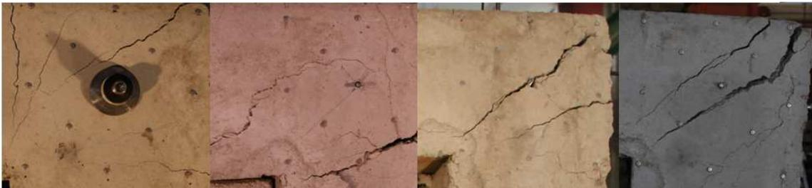
*Figura 59: Situación del nudo tras el ensayo*
