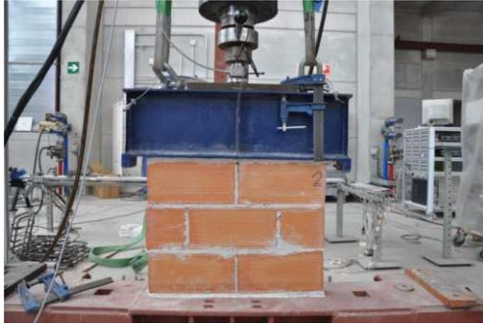
*Figura 26: Ensayo a compresión normal de la fábrica*
