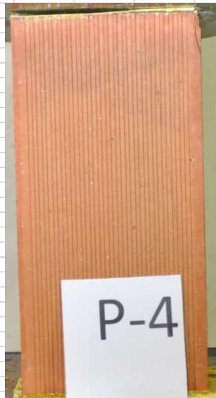
Se ha producido una rotura en toda la parte frontal trasera con desprendimiento. El refrentado consiste en una capa uniforme de azufre de espesor aproximado de 3 mm.
