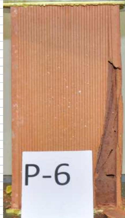
Se ha producido una rotura de la en ambas caras verticales con el despredimiento de la la mitad del lateral derecho inferior. El refrentado consiste en una capa uniforme de azufre de espesor aproximado de 3 mm.
