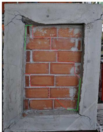
*Figura 60: Modo de fallo relleno Ensayo II*
