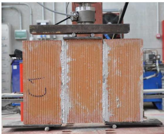
*Figura 28: Ensayo a corte de la fábrica*
