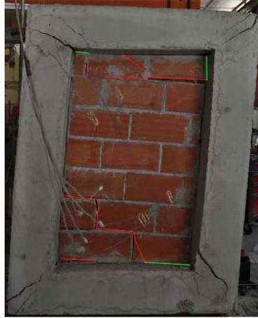
*Figura 62: Modo de fallo relleno Ensayo IV*
