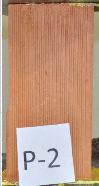
Se ha producido la rotura del laretaI izquierdo. El refrentado consiste en una capa uniforme de azufre de esperor aproximado de 3 mm.
