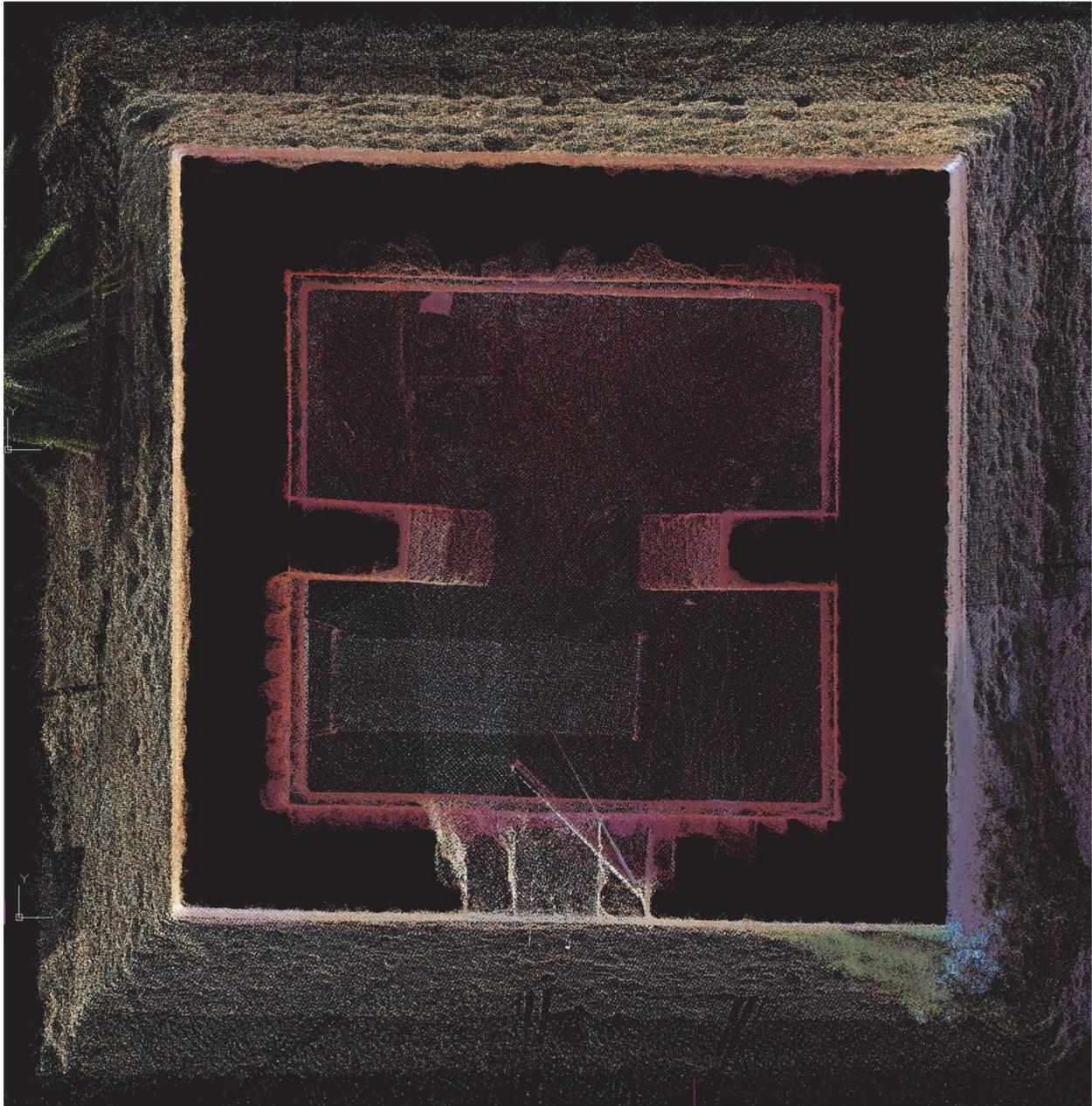
Imagen 101 Sección horizontal de la torre obtenida mediante la nube de puntos del láser escáner, en la que se distingue algunos huecos que podrían deberse a los apoyos de las viguetas en la parte interior del muro SO y NO.
