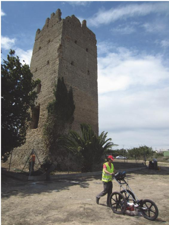
Imagen 10. Vista de la realización de las pruebas del georradar en la parte norte
