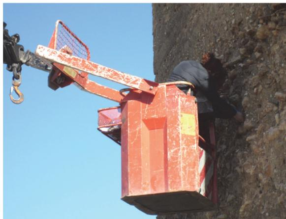
Imagen 108 Toma de la muestra M3 en el exterior de la torre, cara Suroeste, nivel 7 de la tapia.
