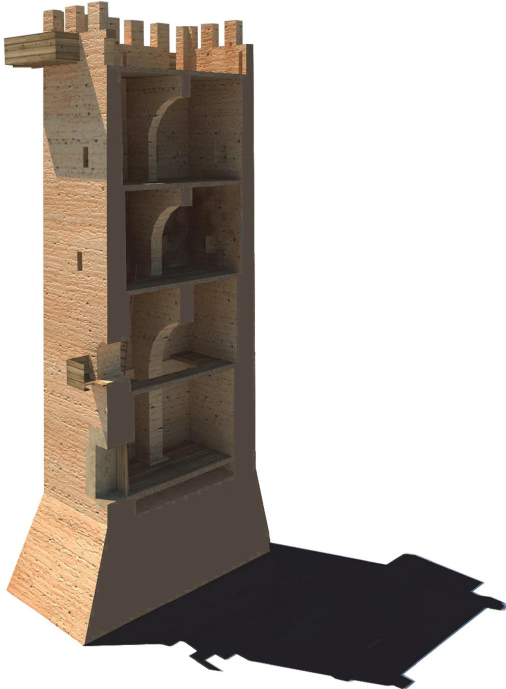
Imagen 60 Primera hipótesis de recomposición virtual de los niveles interiores de la torre, Sección transversal perpendicular al muro interior. Imagen elaborada por Javier Huerta Bononad y Enrique Mezquita Ruiz.
