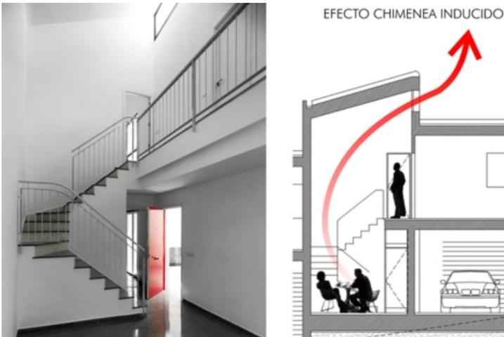
Imagen 68: Las diferentes presiones del aire pueden sacar el aire a través de un edificio.
