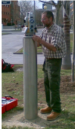
Figura 1.2: Estación total sobre vértice V3
