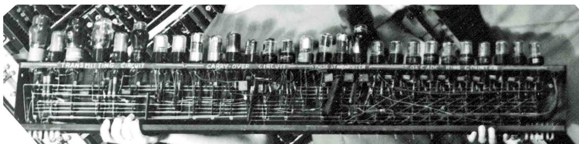
Imagen 27 – Detalle del contador de décadas
