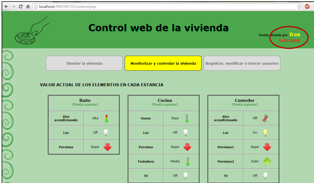
Ilustración 41: Pantalla principal y única del supervisor (monitorización I)
