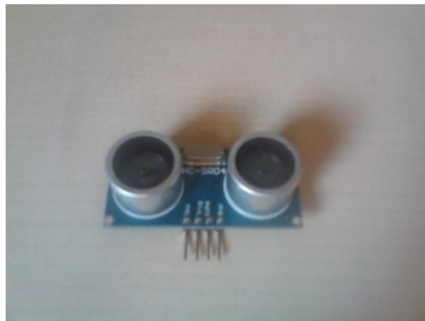
Ilustración 41: Sensor de ultrasonidos
