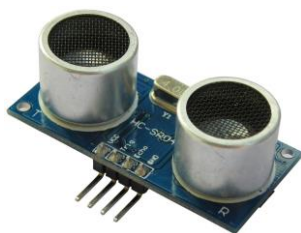
Ilustración 35: Sensor de ultrasonidos
